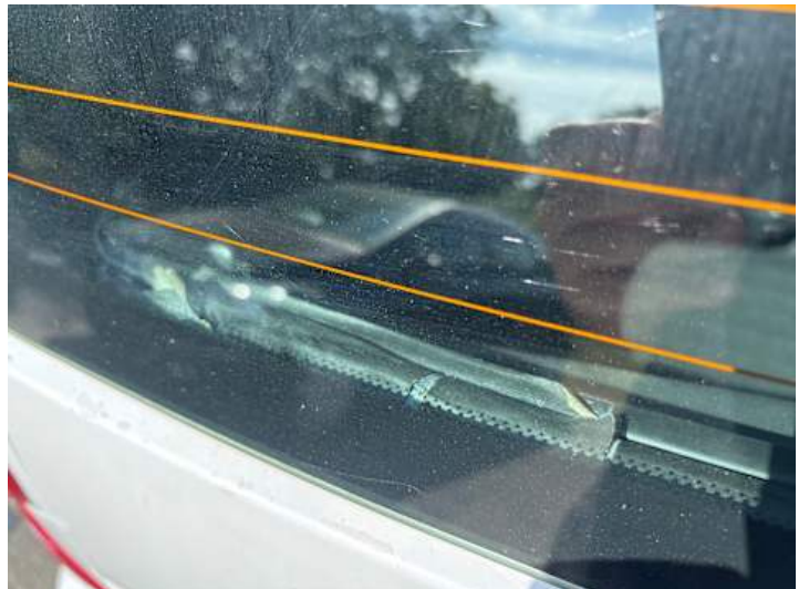
Innenraum (Riss/Bruch, Anderer Schaden): Innenverkleidung geklebt
