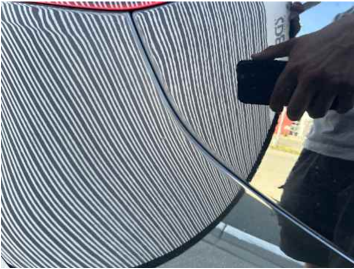
Stoßstange hinten (Unsachgemäß instand gesetzt)
