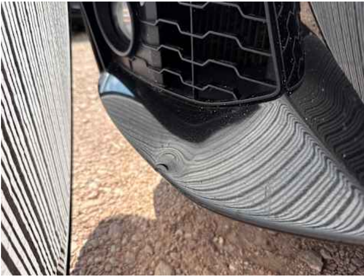
Stoßstange vorne (Verformung)
