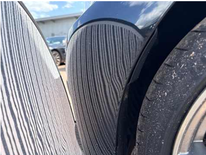
Stoßstange vorne (Verformung)
