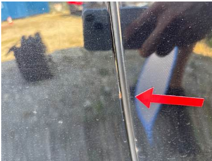
Fahrtür (Kratzer, Rost)
