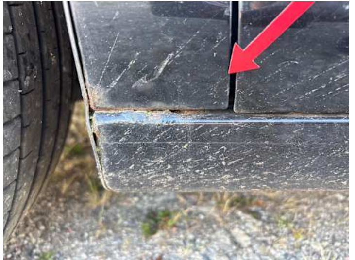
Schweller links (Rost)
