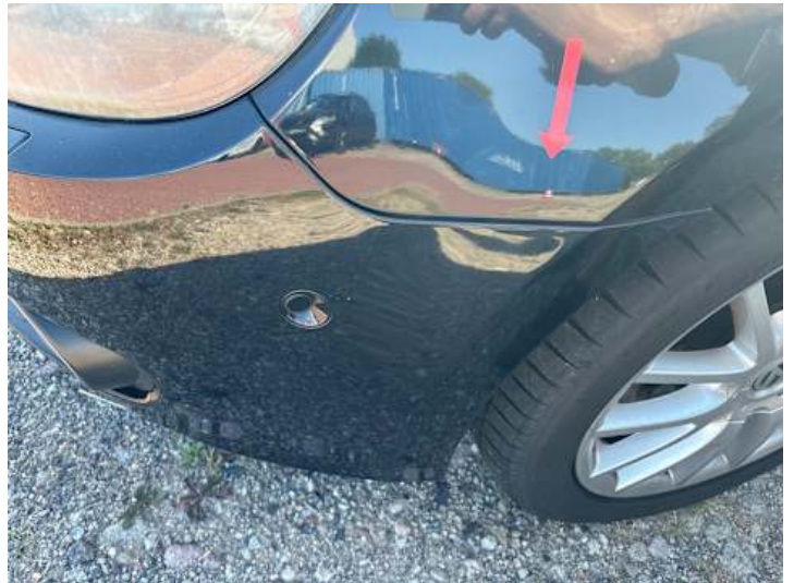
Stoßstange vorne (Spaltmaße ungenau)
