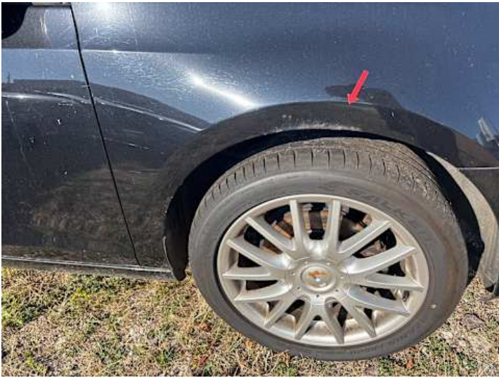
Kotflügel vorne rechts (Rost)
