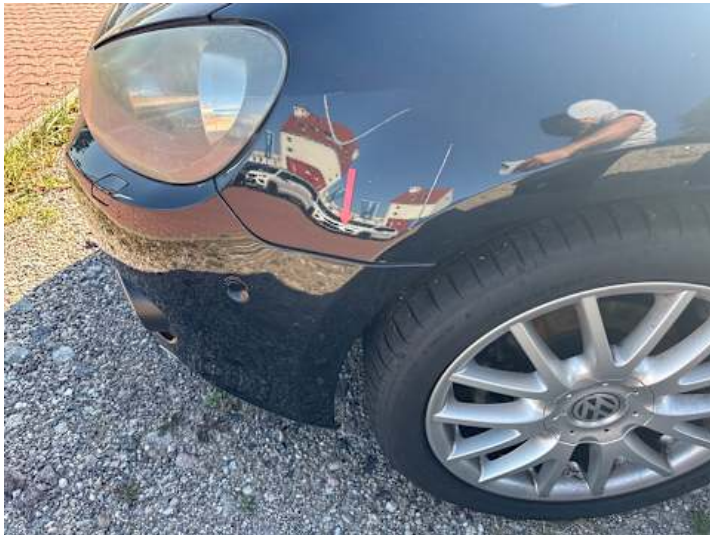
Stoßstange vorne (Spaltmaße ungenau)
