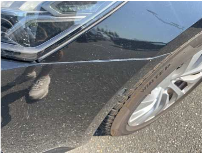
Stoßstange vorne (Unsachgemäß instand gesetzt)
