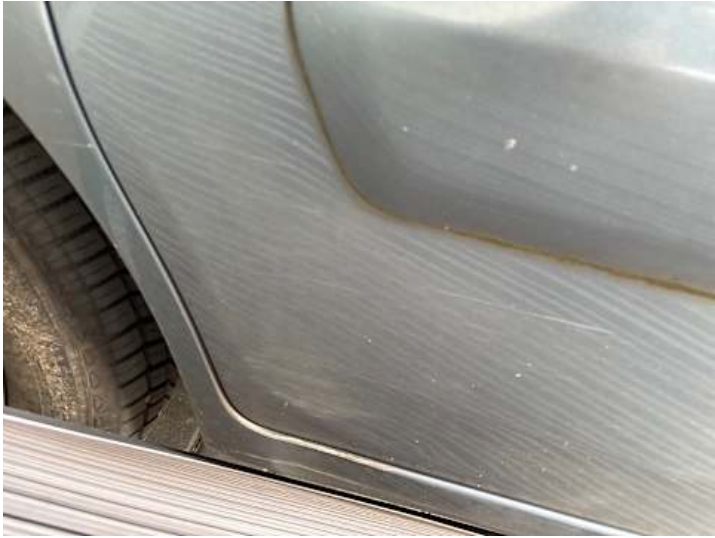
Türe hinten rechts (Verformung)
