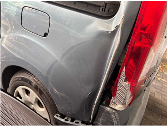
Seitenteil hinten links (Verformung)
