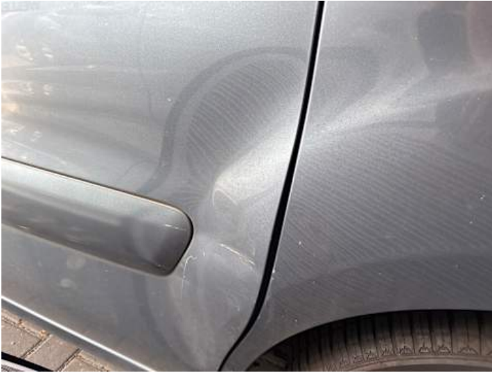
Türe hinten links (Verformung)
