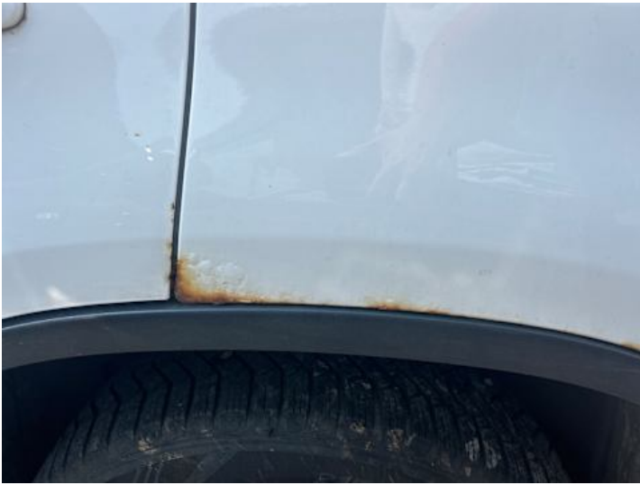
Seitenteil hinten links (Rost)
