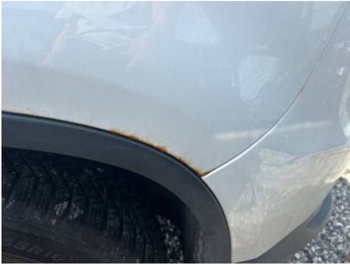
Seitenteil hinten links (Rost)
