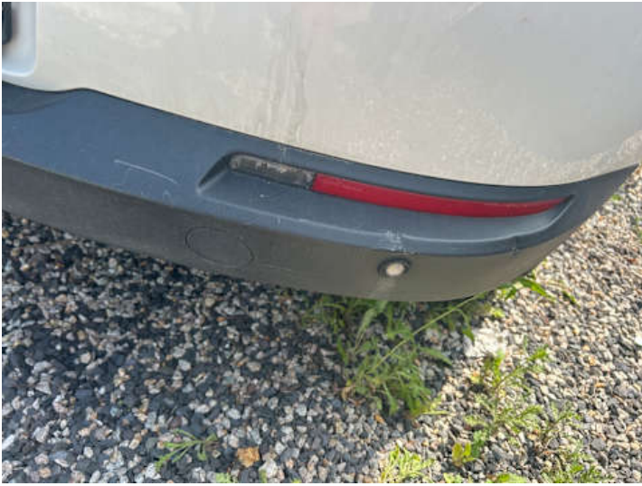
Stoßstange hinten (Kratzer, Delle)
