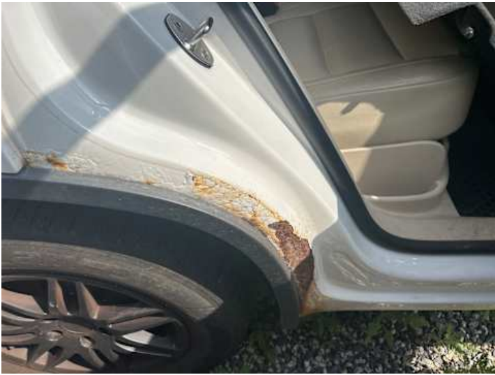
Türe hinten rechts (Rost)
