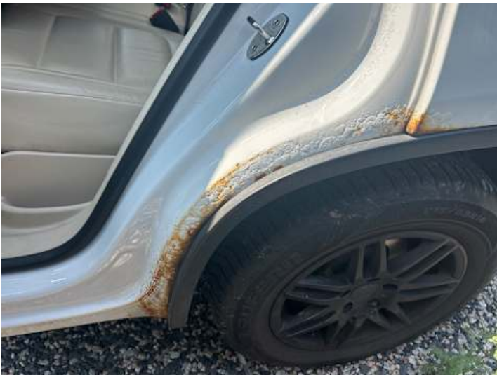
Türe hinten links (Rost)
