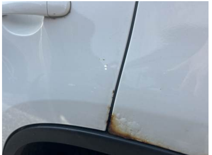
Türe hinten links (Rost)
