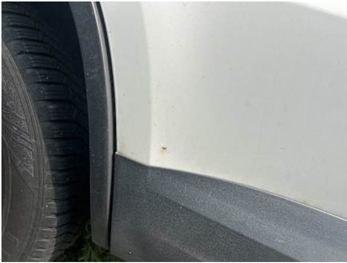
Türe hinten rechts (Rost)
