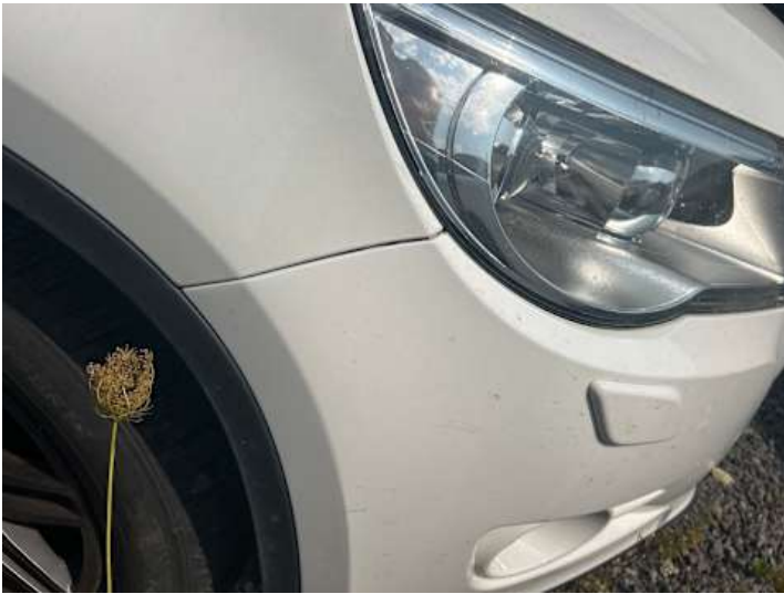
Stoßstange vorne (Spaltmaße ungenau)
