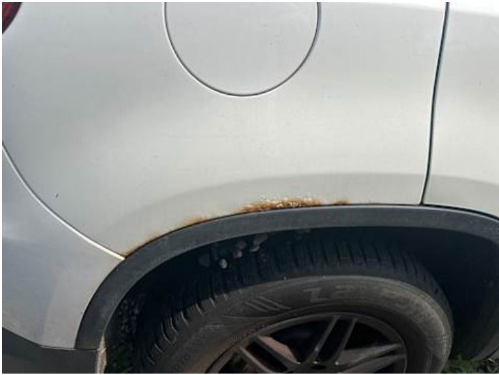
Seitenteil hinten rechts (Rost)
