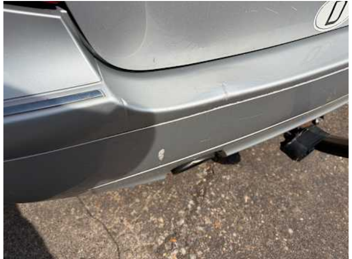
Stoßstange hinten (Riss/Bruch)
