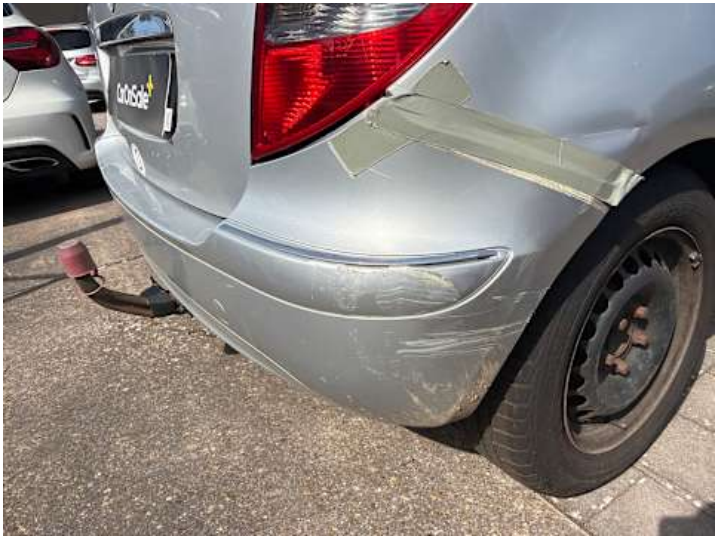
Stoßstange hinten (Riss/Bruch)
