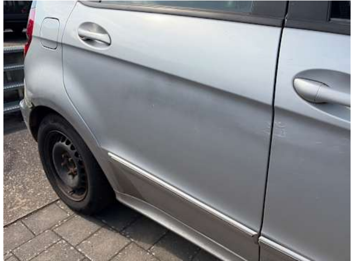
Türe hinten rechts (Verformung, Kratzer)
