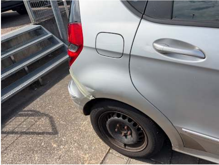
Seitenteil hinten rechts (Verformung, Kratzer)
