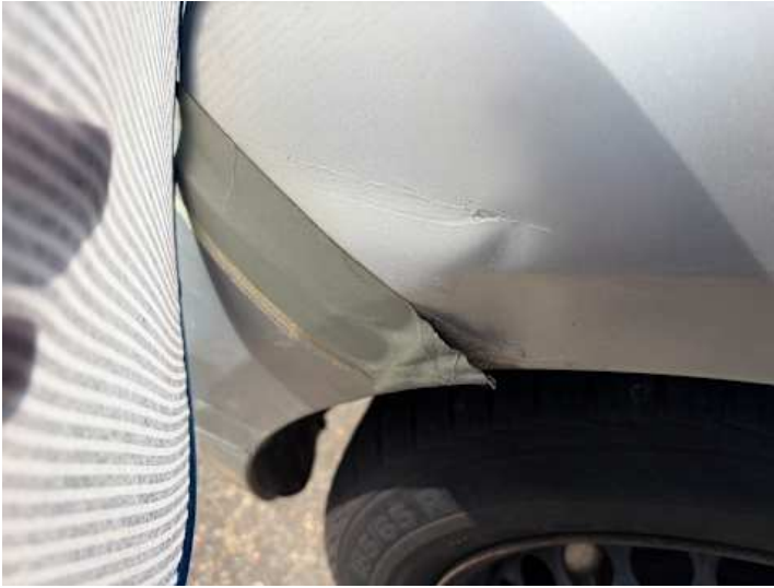
Seitenteil hinten rechts (Verformung, Kratzer)
