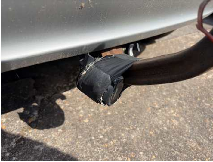
Stoßstange hinten (Riss/Bruch, Anderer Schaden): Anhänger Steckdose;
