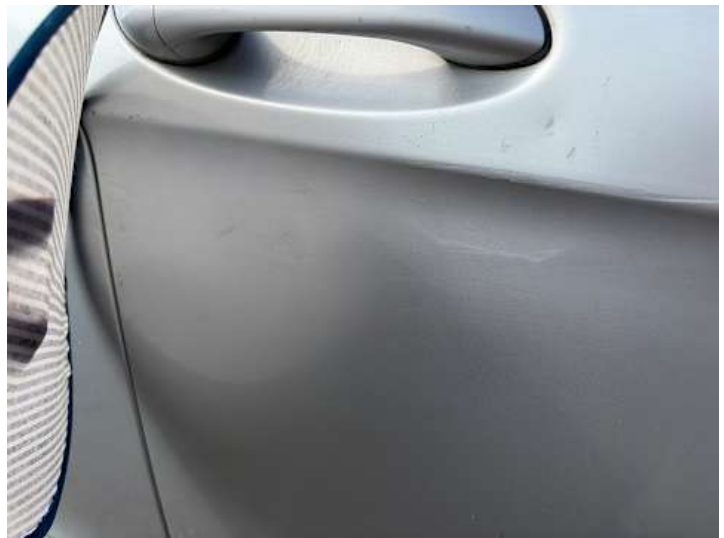
Beifahrertür (Verformung, Kratzer)
