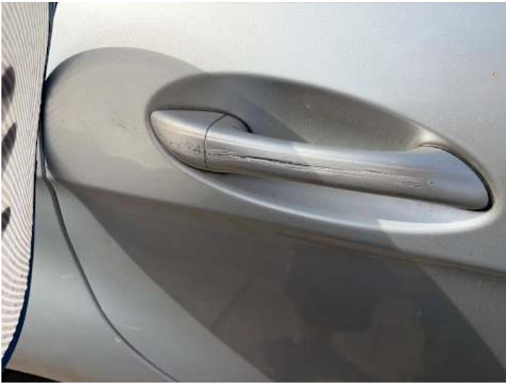
Türe hinten rechts (Verformung, Kratzer)
