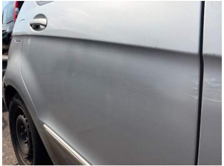
Türe hinten rechts (Verformung, Kratzer)
