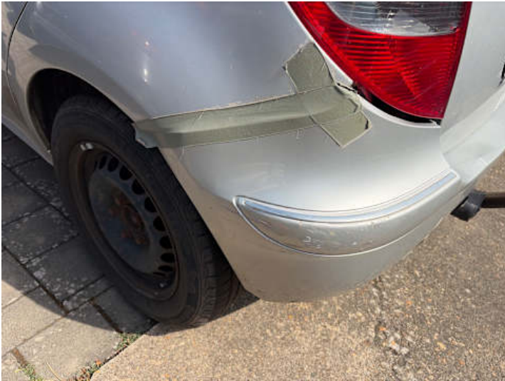
Stoßstange hinten (Riss/Bruch)
