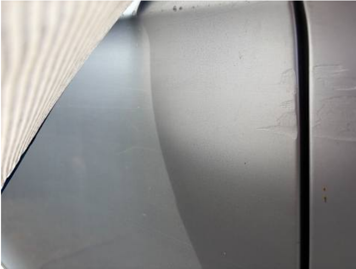
Türe hinten rechts (Verformung, Kratzer)
