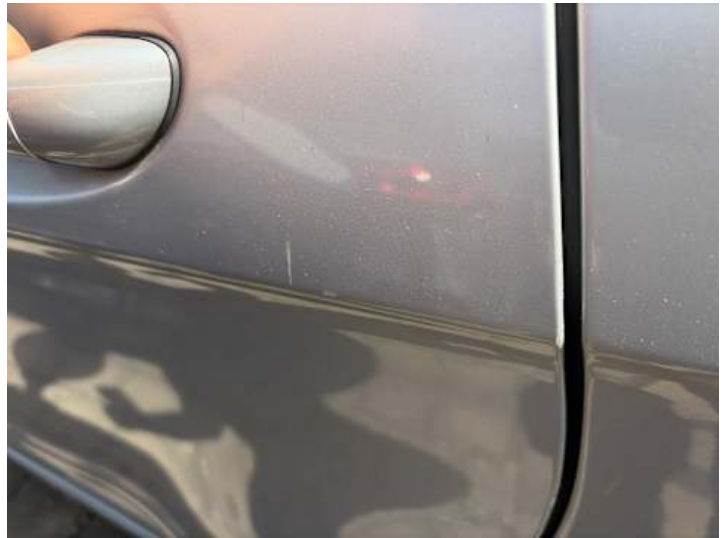
Türe hinten links (Kratzer)
