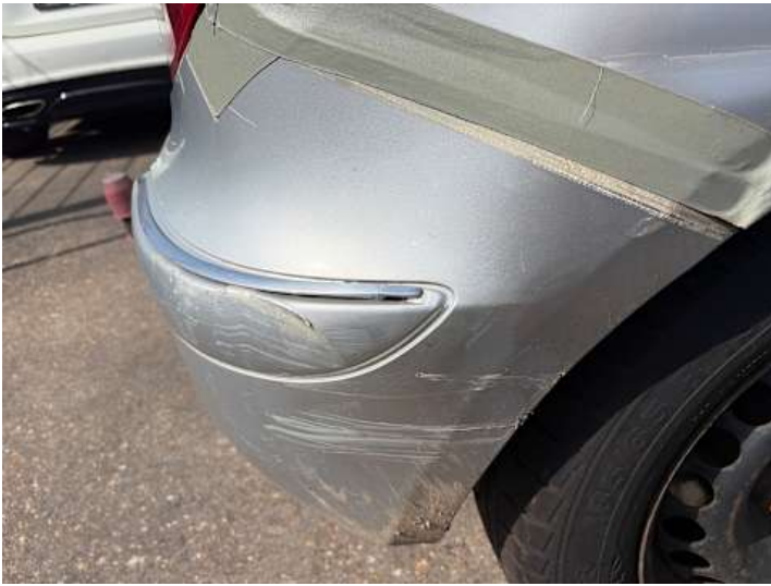
Stoßstange hinten (Riss/Bruch)
