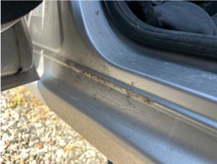
Schweller links (Rost)
