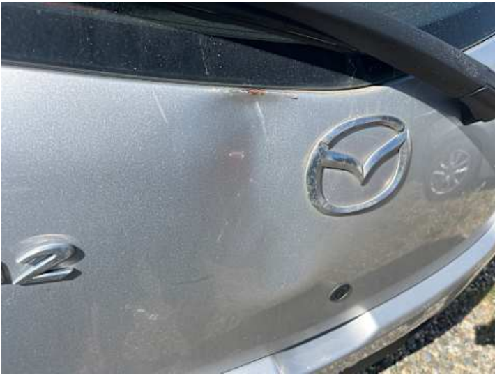
Heckklappe (Verformung, Lackschaden, Rost)
