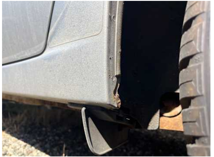
Schweller links (Rost)
