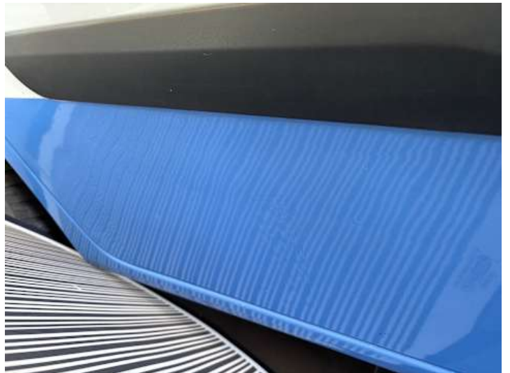
Türe hinten rechts (Verformung)
