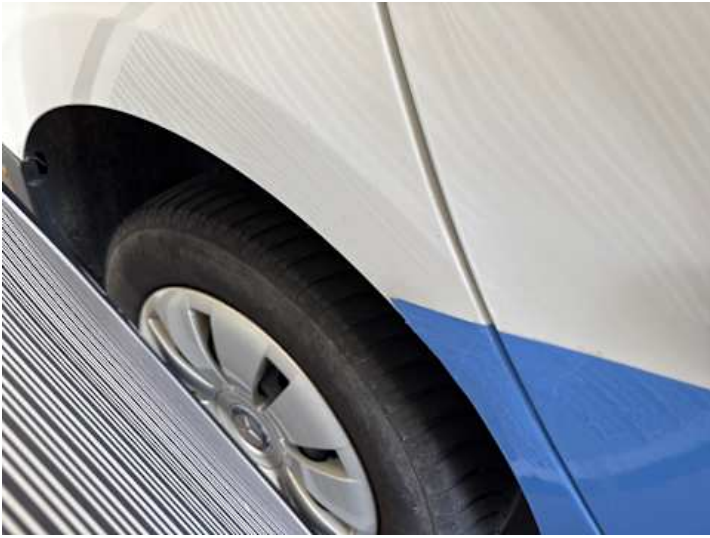
Seitenteil hinten rechts (Verformung, Lackschaden)
