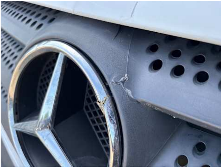
Stoßstange vorne (Riss/Bruch, Kratzer)
