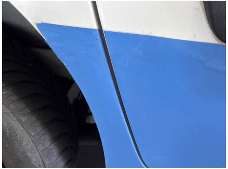
Seitenteil hinten rechts (Verformung, Lackschaden)
