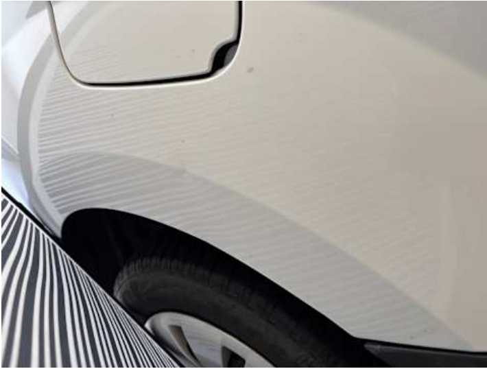
Seitenteil hinten links (Delle)
