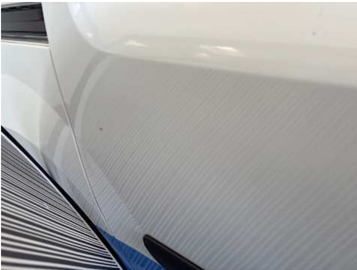
Türe hinten rechts (Verformung)
