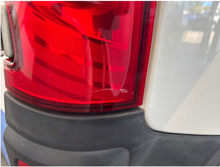
Rücklicht (rechts) (Riss/Bruch)
