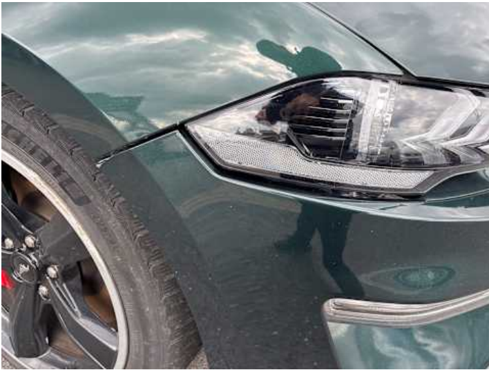
Stoßstange vorne (Spaltmaße ungenau)
