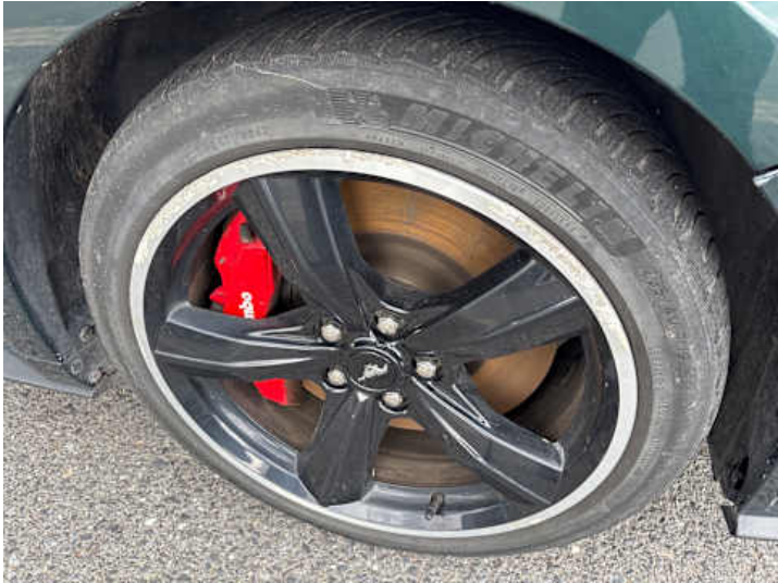
Rad (Ungleichmäßig abgefahren, Kratzer)
