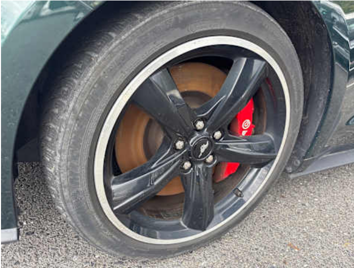
Rad (Ungleichmäßig abgefahren, Kratzer)
