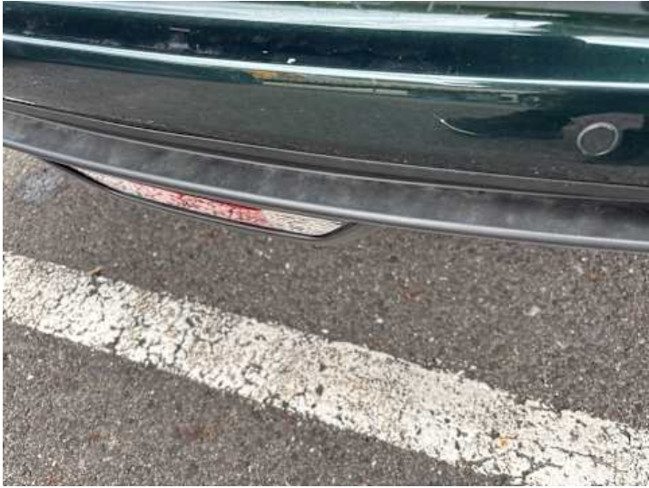
Stoßstange hinten (Kratzer)
