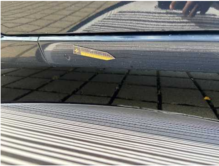
Schweller links (Kratzer, Delle)
