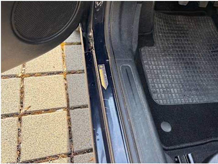
Schweller links (Kratzer, Delle)
