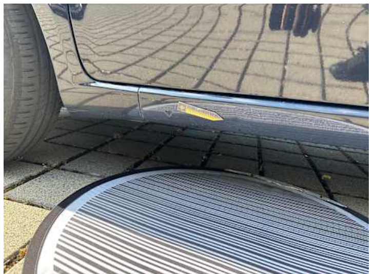
Schweller links (Kratzer, Delle)
