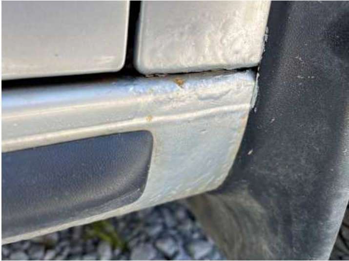
Schweller rechts (Rost)
