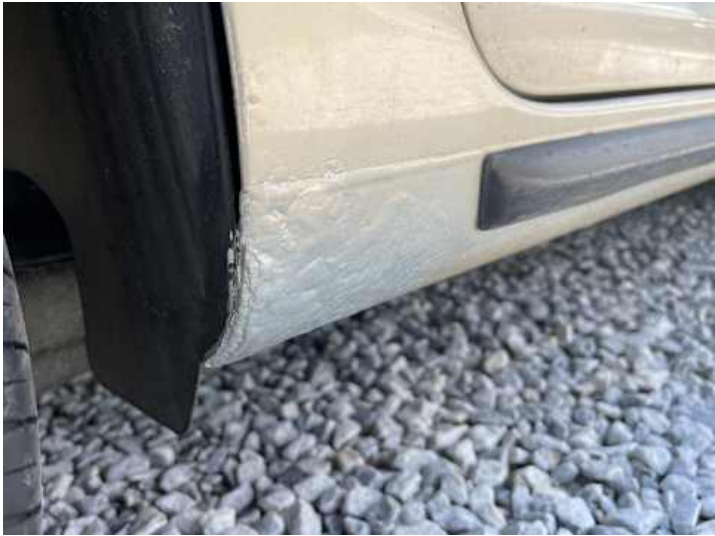
Schweller rechts (Rost)
