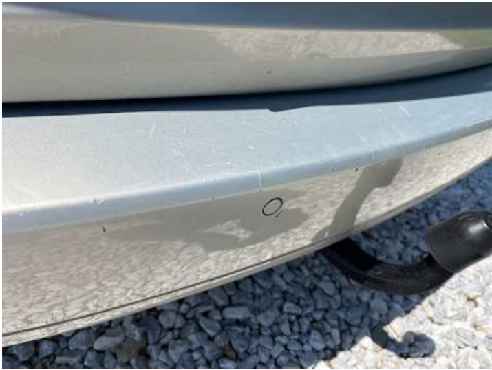
Stoßstange hinten (Kratzer, Lackschaden)
