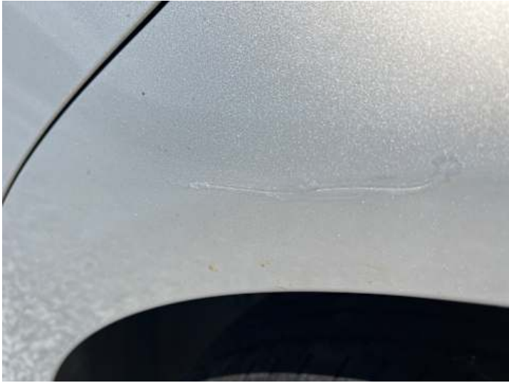
Seitenteil hinten links (Kratzer)
