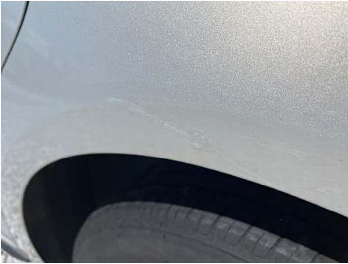
Seitenteil hinten links (Kratzer)
