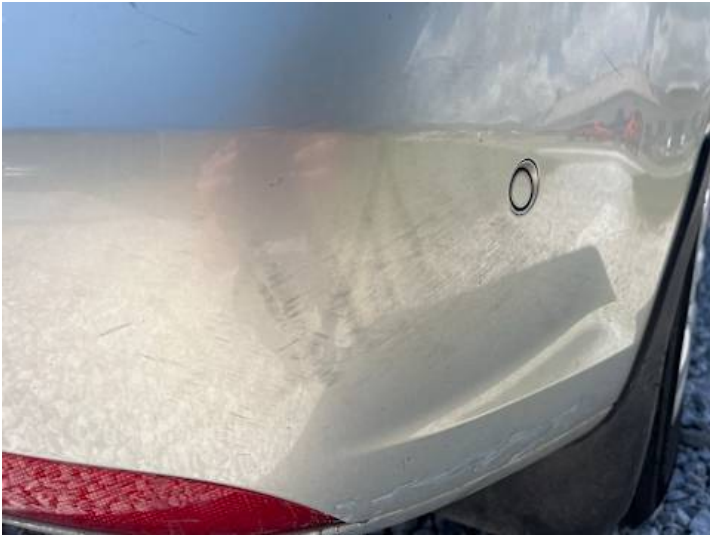
Stoßstange hinten (Kratzer, Lackschaden)
