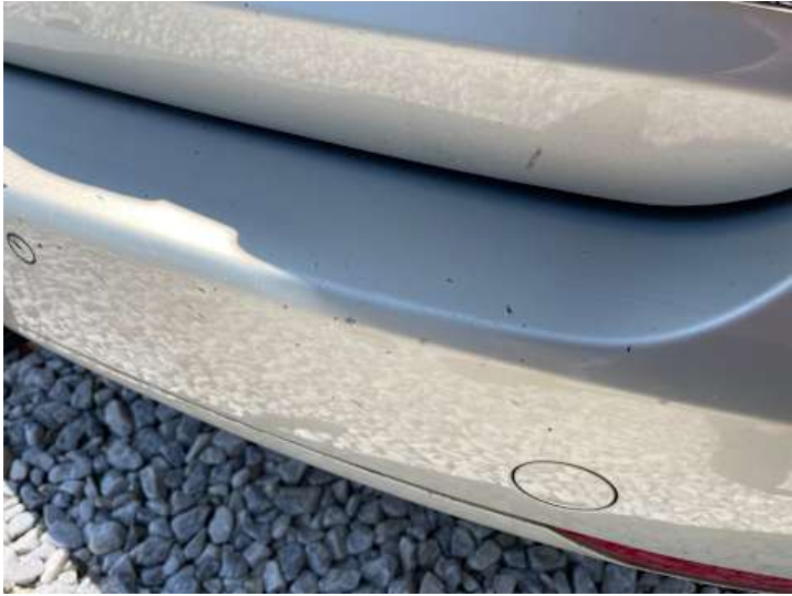
Stoßstange hinten (Kratzer, Lackschaden)
