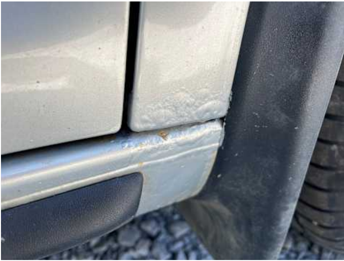
Kotflügel vorne rechts (Rost)
