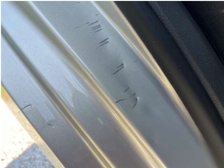
Seitenteil hinten rechts (Kratzer, Delle)
