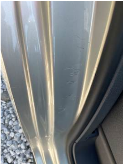
Seitenteil hinten rechts (Kratzer, Delle)
