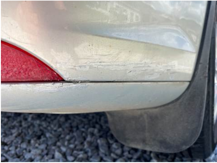
Stoßstange hinten (Kratzer, Lackschaden)
