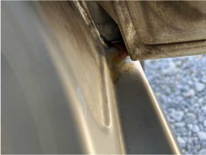
Schweller rechts (Rost)
