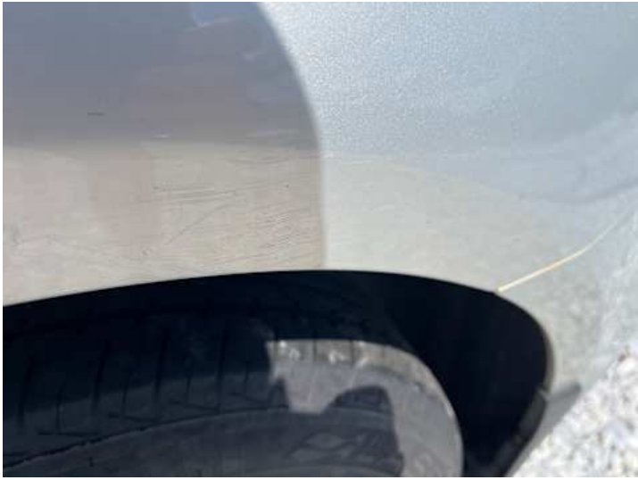
Seitenteil hinten links (Kratzer)
