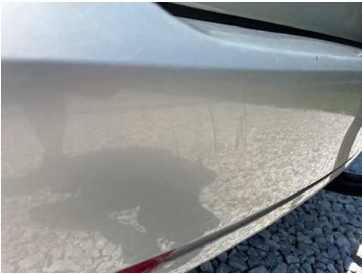
Stoßstange hinten (Kratzer, Lackschaden)
