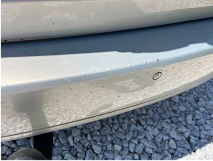
Stoßstange hinten (Kratzer, Lackschaden)
