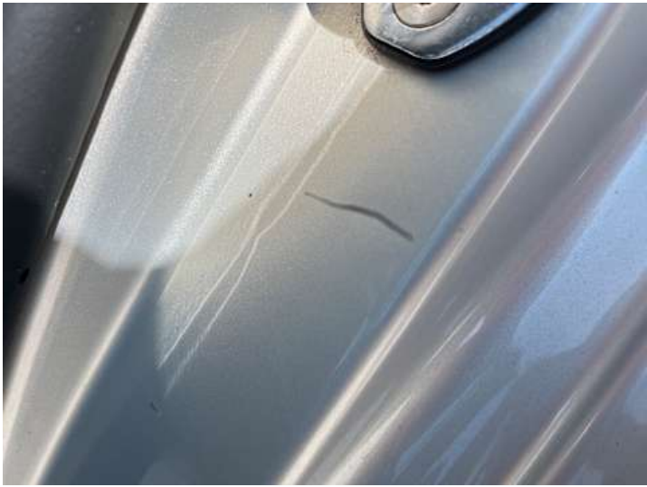
Seitenteil hinten links (Kratzer)
