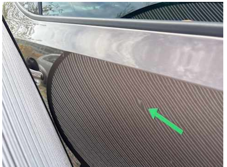
Türe hinten rechts (Delle)
