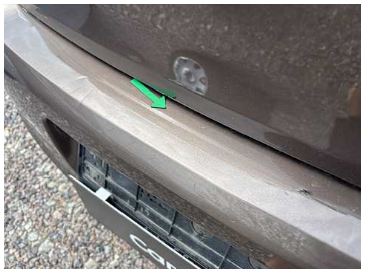
Stoßstange hinten (Lackschaden, Verformung, Riss/Bruch)
