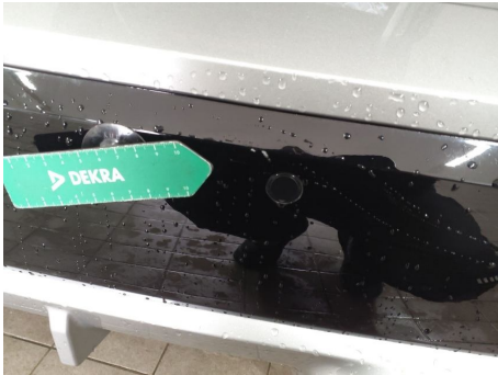
Stoßfängerleiste / Hinten / Kratzer
