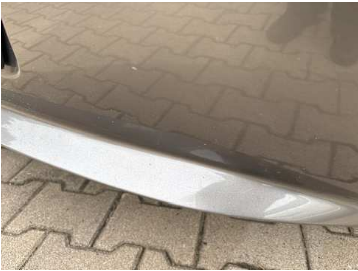
Stoßstange hinten (Verformung)
