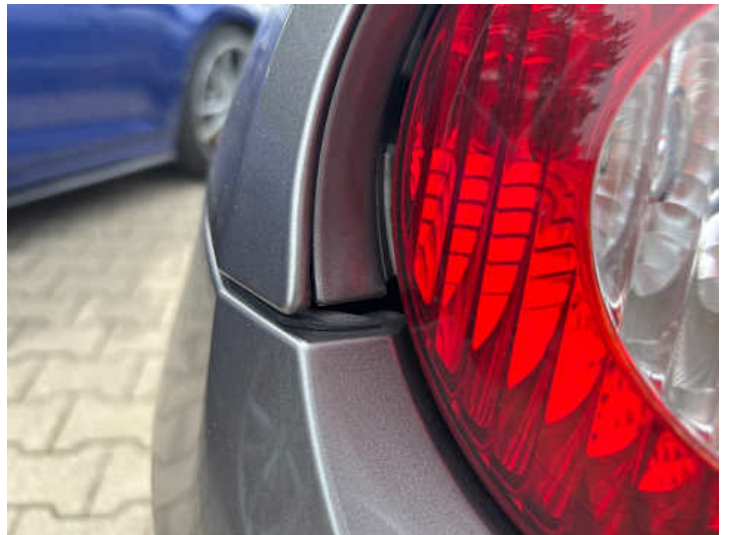
Rücklicht (links) (Riss/Bruch)
