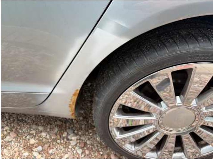
Seitenteil hinten links (Lackschaden, Rost)
