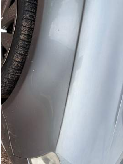
Kotflügel vorne rechts (Steinschlag, Lackschaden)
