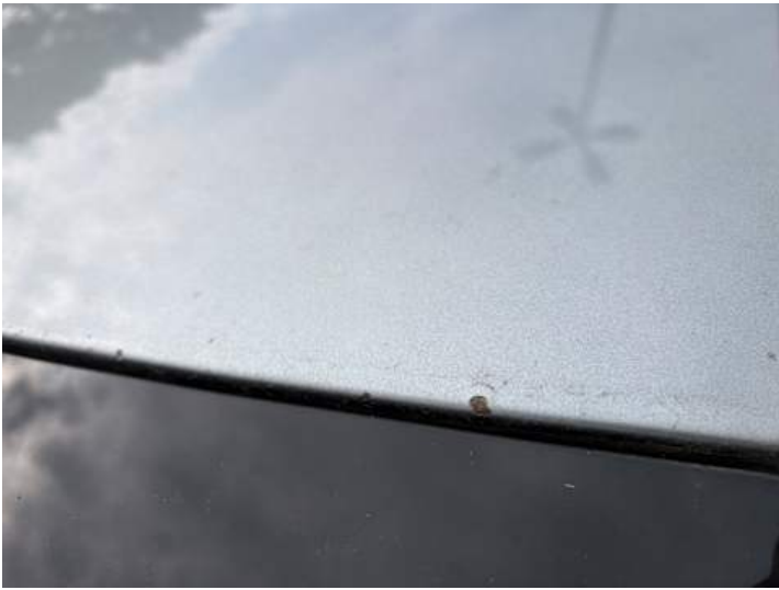
Dach (Steinschlag, Lackschaden)
