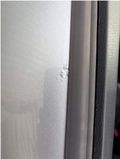
Fahrtür (Rost, Lackschaden)
