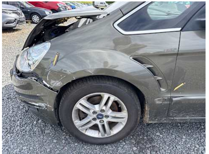
Kotflügel vorne links (Riss/Bruch, Verformung)
