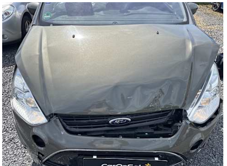
Motorhaube (Verformung, Kratzer)
