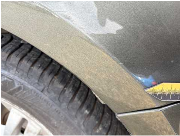
Seitenteil hinten links (Steinschlag)
