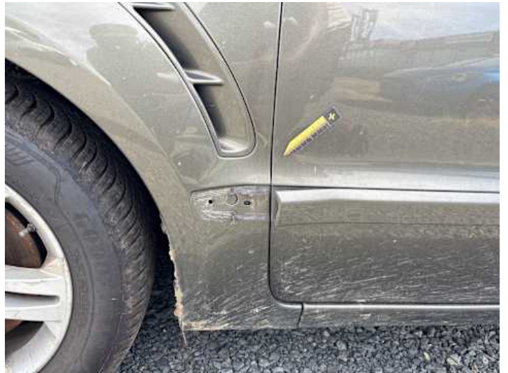
Kotflügel vorne links (Riss/Bruch, Verformung)
