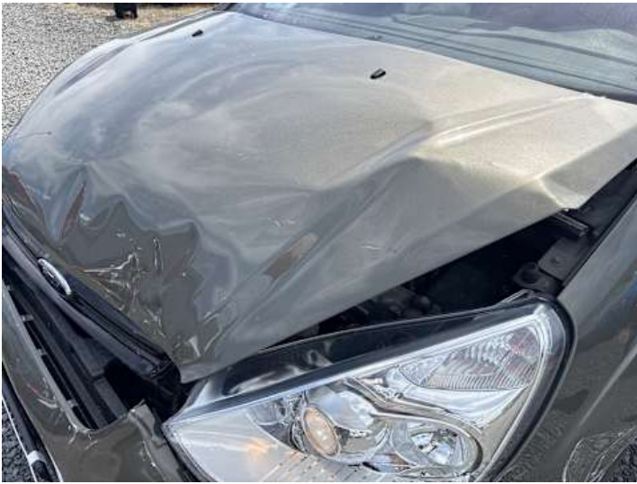
Motorhaube (Verformung, Kratzer)
