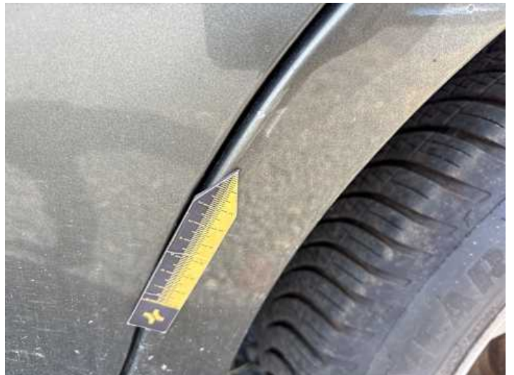
Seitenteil hinten links (Steinschlag)
