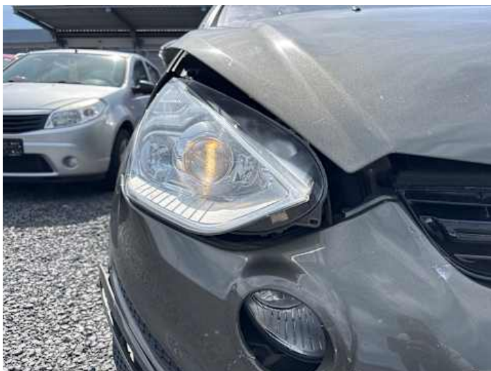
Scheinwerfer (rechts) (Riss/Bruch)
