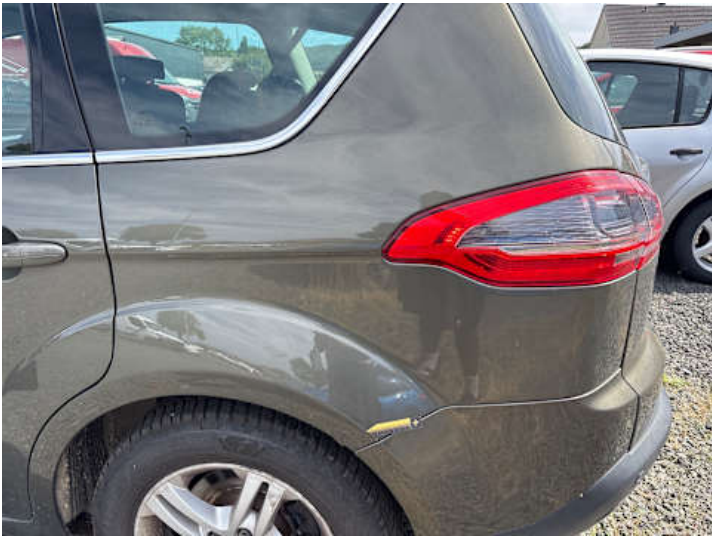
Seitenteil hinten links (Steinschlag)
