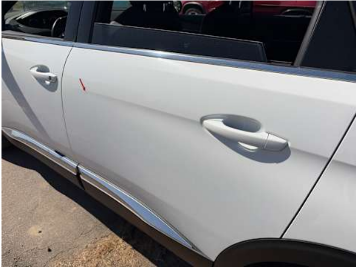
Türe hinten links (Kratzer, Delle)
