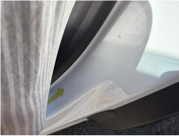
Türe hinten links (Kratzer, Delle)
