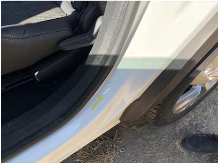
Türe hinten links (Kratzer, Delle)
