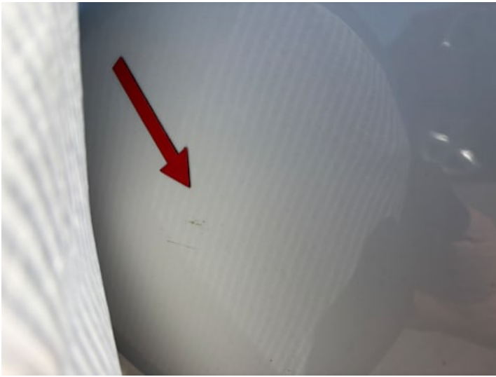
Beifahrertür (Delle, Kratzer)
