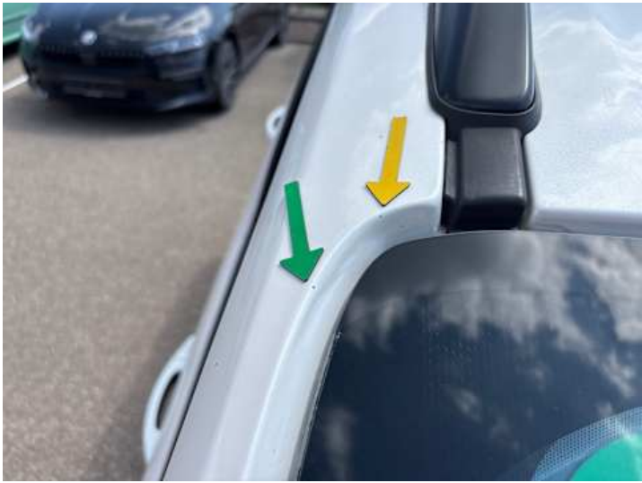
Seitenteil hinten rechts (Steinschlag)
