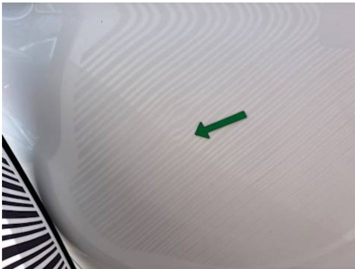
Türe hinten rechts (Delle)
