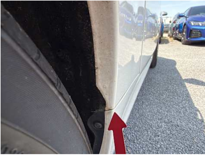
Seitenteil hinten rechts (Rost)
