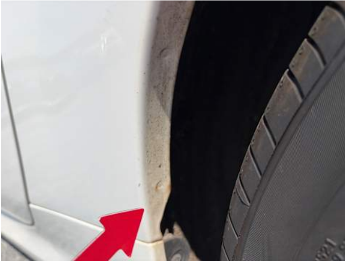
Seitenteil hinten links (Rost)
