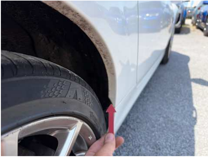
Seitenteil hinten rechts (Rost)
