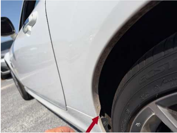
Seitenteil hinten links (Rost)
