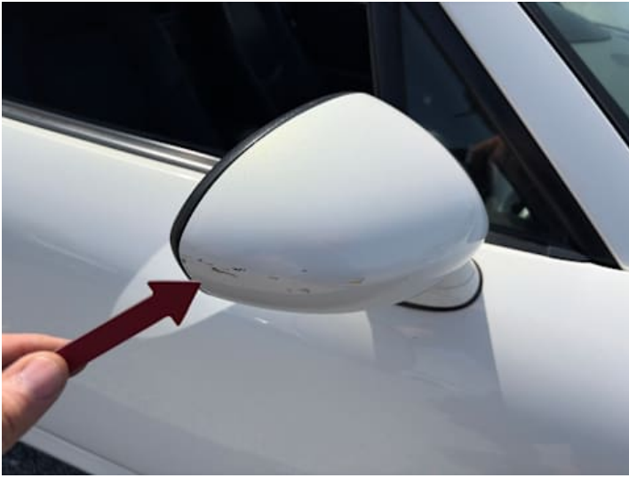
Beifahrertür (Kratzer, Delle)
