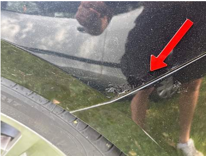
Seitenteil hinten links (Lackschaden, Rost)
