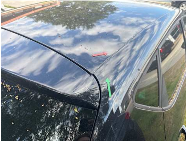
Dach (Delle, Anderer Schaden): Mehrere kleine Dellen über dem Dach
