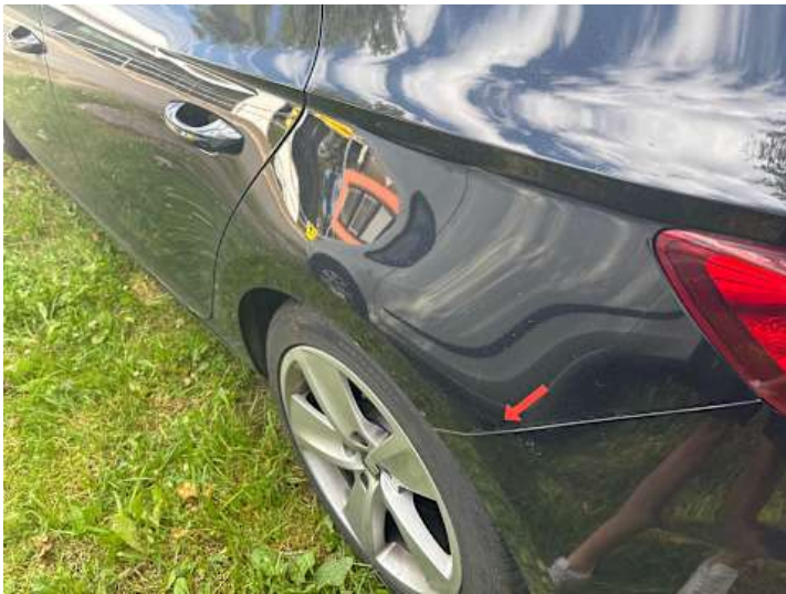
Seitenteil hinten links (Lackschaden, Rost)
