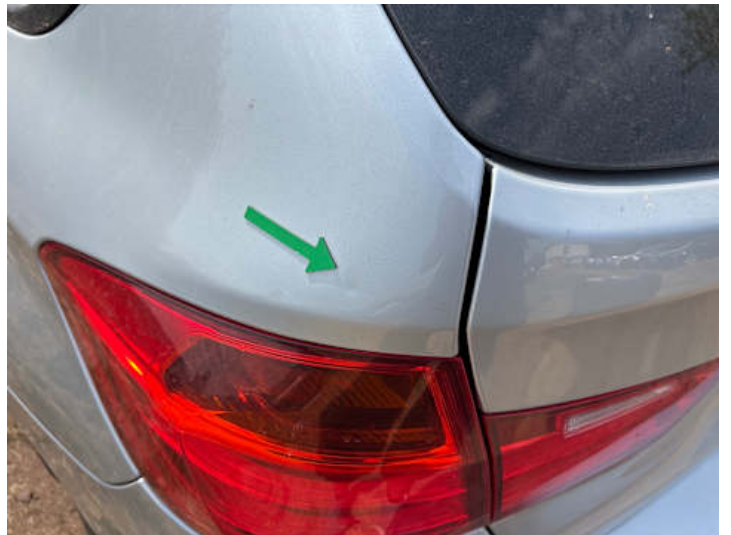
Seitenteil hinten links (Delle)
