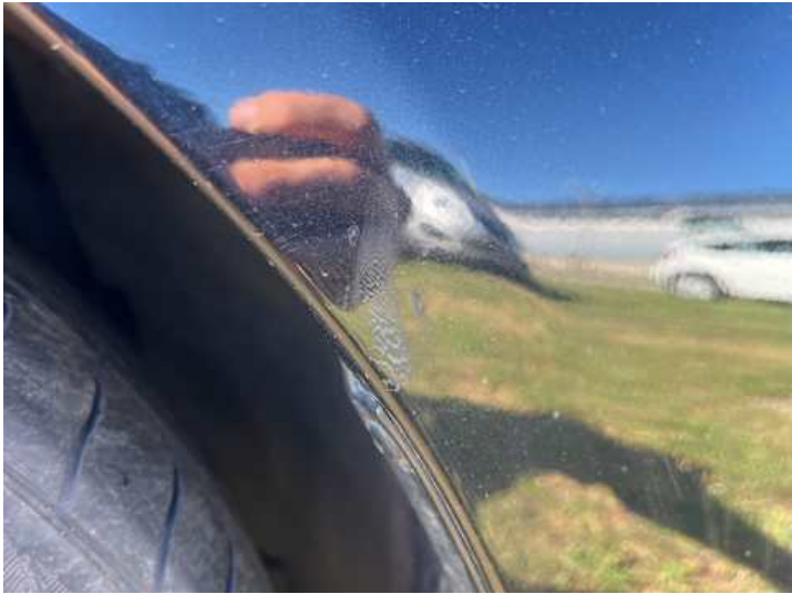
Kotflügel vorne links (Delle, Kratzer)
