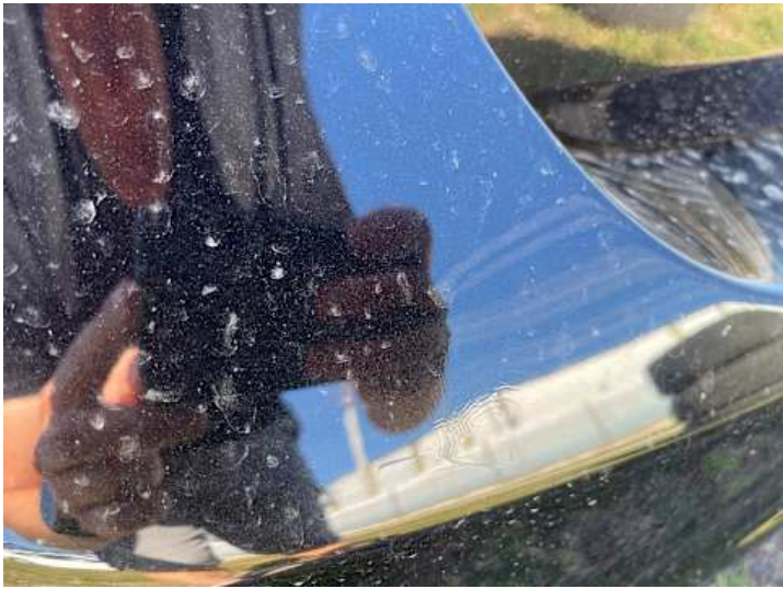
Stoßstange hinten (Kratzer, Lackschaden)
