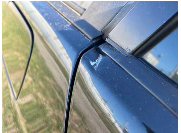
Türe hinten rechts (Kratzer, Delle)
