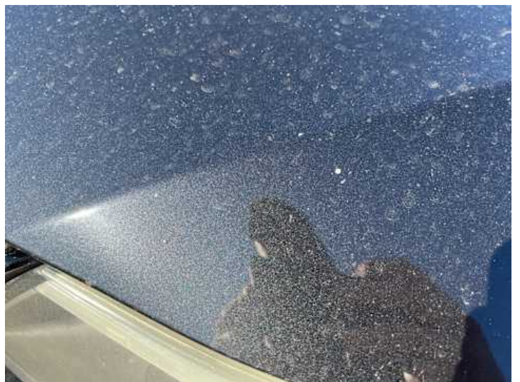
Motorhaube (Steinschlag, Rost)
