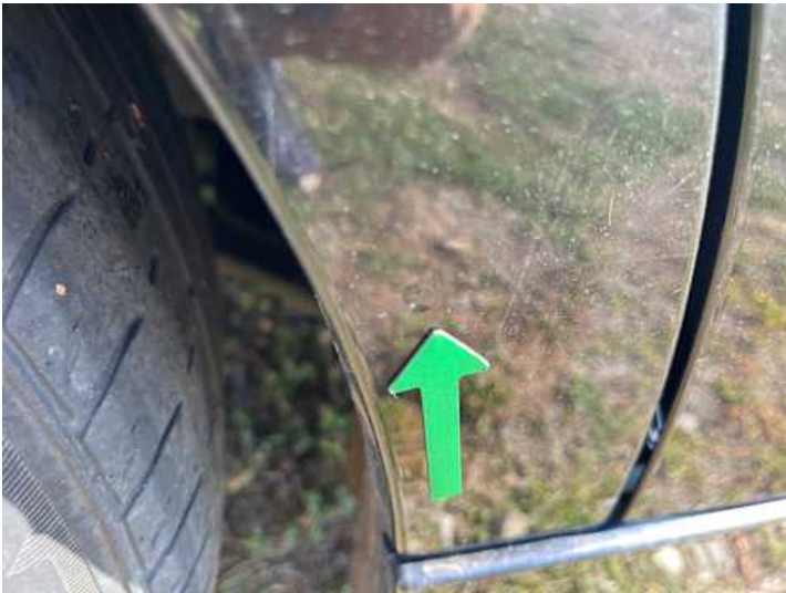
Seitenteil hinten rechts (Rost, Lackschaden)
