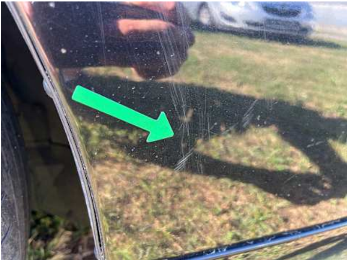
Kotflügel vorne links (Delle, Kratzer)
