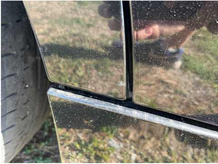
Seitenteil hinten rechts (Rost, Lackschaden)
