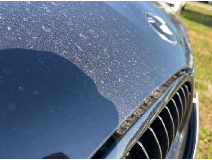
Motorhaube (Steinschlag, Rost)
