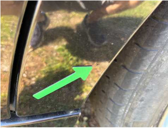
Seitenteil hinten links (Rost)
