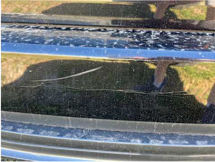
Stoßstange hinten (Kratzer, Lackschaden)
