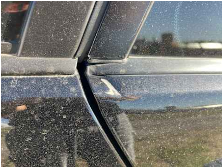
Türe hinten rechts (Kratzer, Delle)
