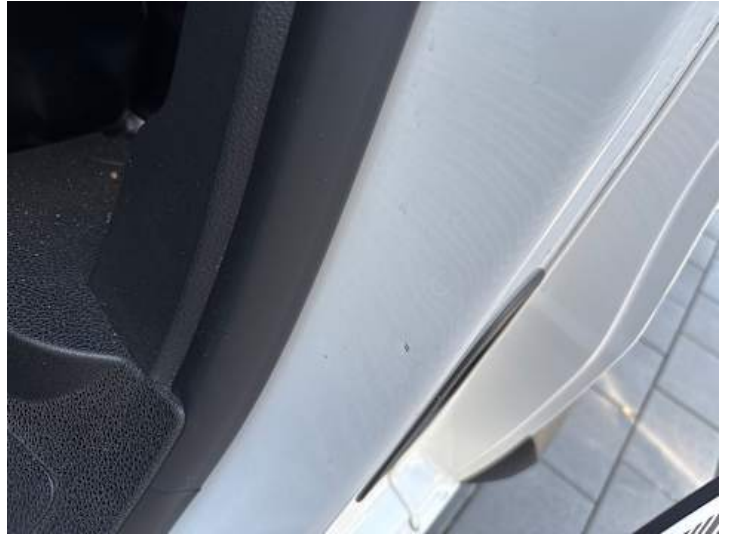
Schweller links (Delle, Kratzer)
