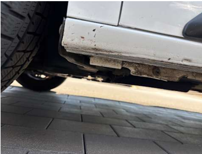
Schweller links (Verformung)
