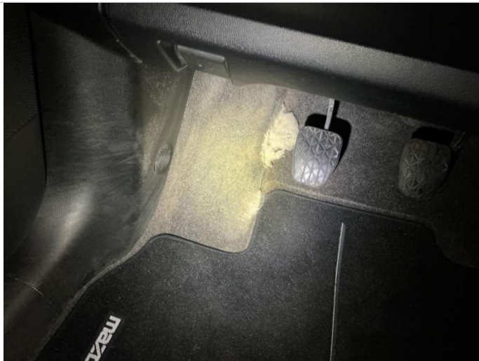
Teppich Fahrerfußraum beschädigt.
