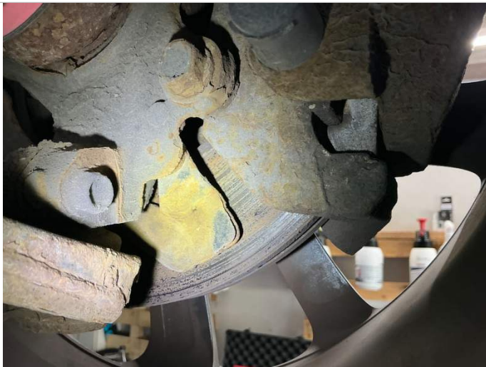
Bremsscheiben vorn Tragbild mangelhaft.
