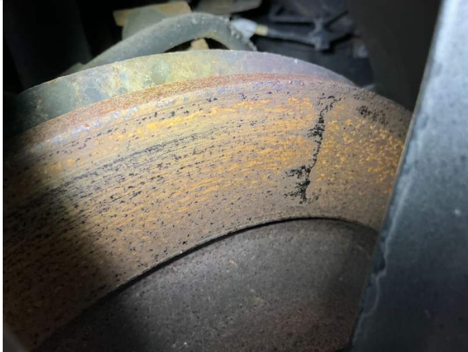
Bremsscheiben hinten Tragbild mangelhaft.
