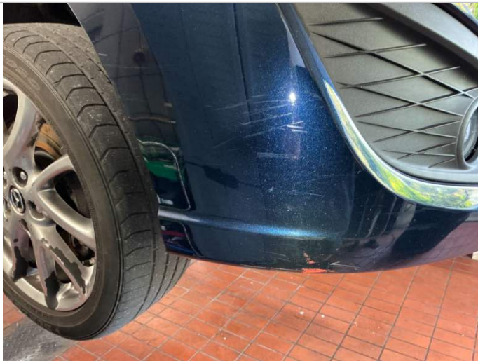
Stoßfänger vorn Lackbeschädigung.
