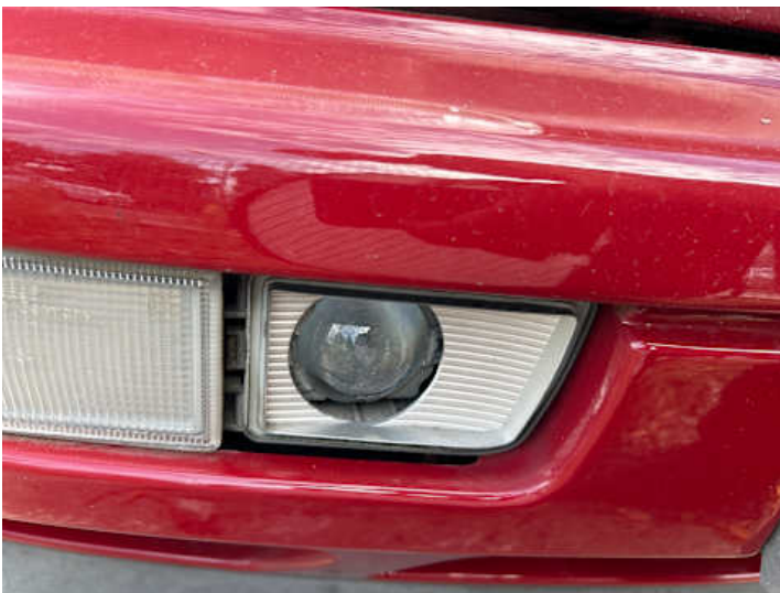
Scheinwerfer (rechts) (Riss/Bruch)
