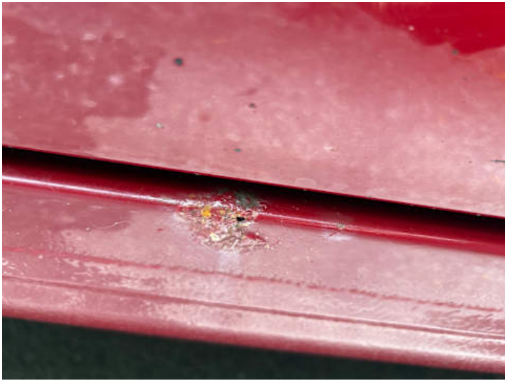
Schweller links (Rost)
