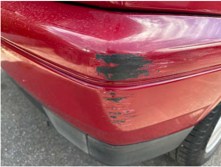
Stoßstange hinten (Lackschaden)
