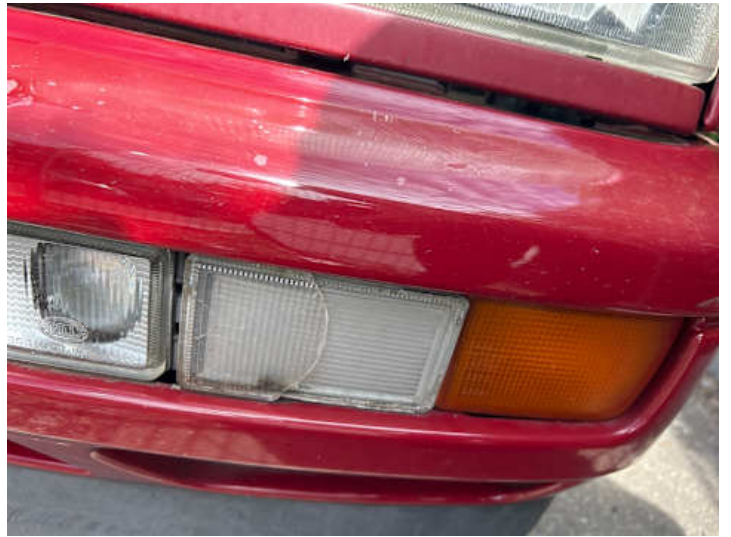
Scheinwerfer (links) (Riss/Bruch)
