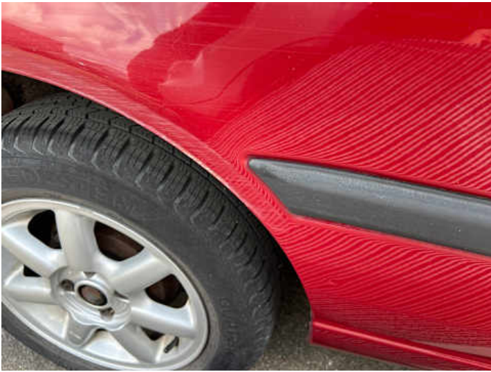
Seitenteil hinten rechts (Lackschaden, Delle)
