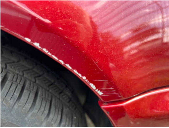
Kotflügel vorne rechts (Lackschaden)
