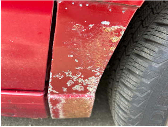
Kotflügel vorne rechts (Rost)
