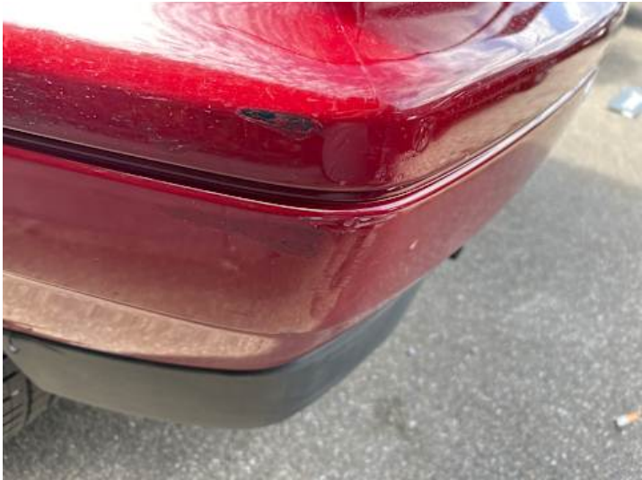
Stoßstange hinten (Lackschaden)
