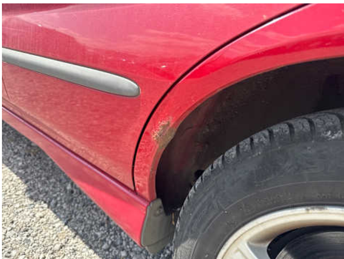
Seitenteil hinten links (Kratzer, Delle, Rost)
