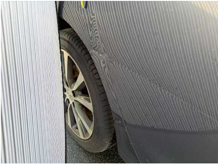
Seitenteil hinten rechts (Delle, Verformung)
