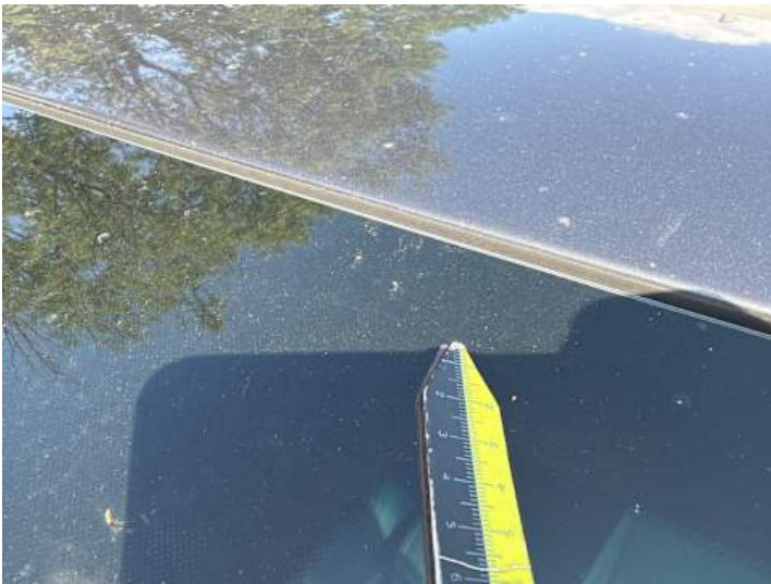
Dach (Lackschaden, Steinschlag)
