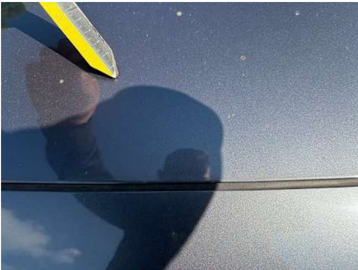
Motorhaube (Lackschaden, Steinschlag, Kratzer)
