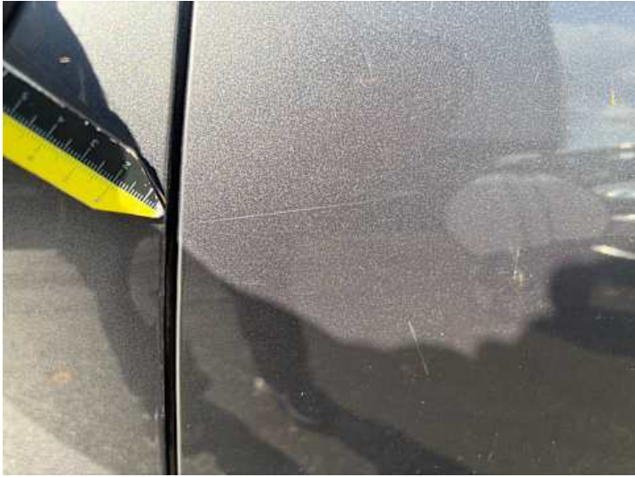
Türe hinten links (Lackschaden, Kratzer)
