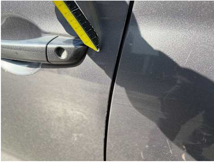
Fahrtür (Lackschaden, Kratzer)
