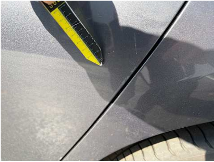
Türe hinten links (Lackschaden, Kratzer)
