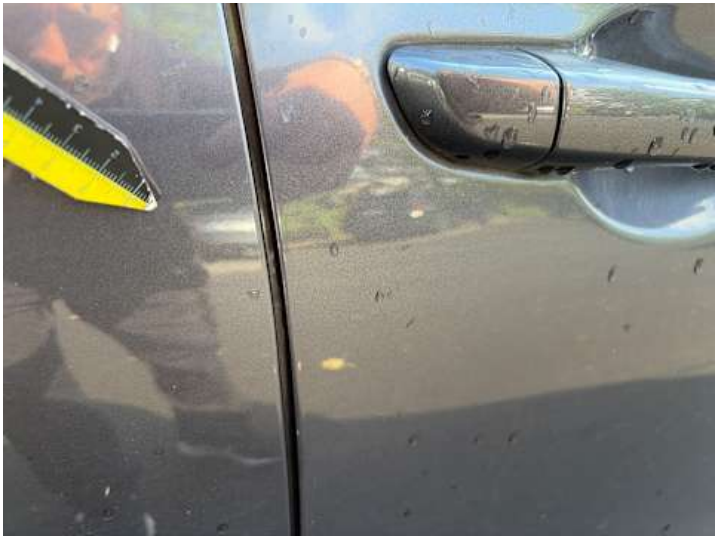
Beifahrertür (Lackschaden, Kratzer)
