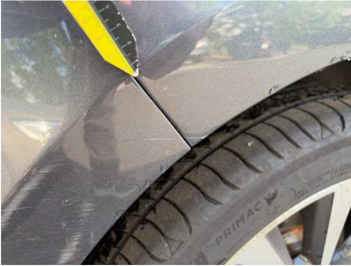
Seitenteil hinten rechts (Lackschaden, Kratzer)
