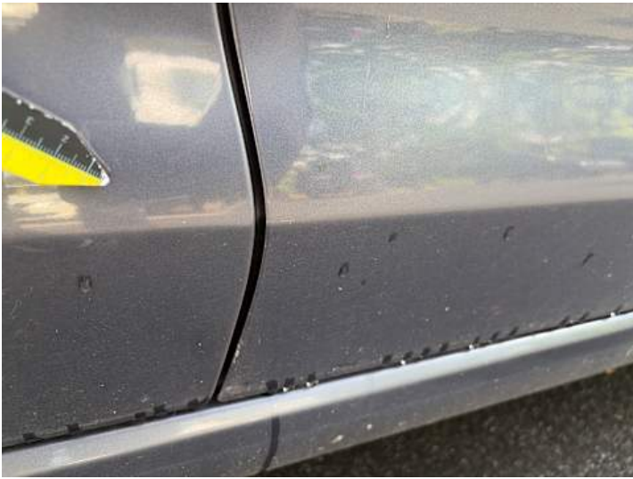
Beifahrertür (Lackschaden, Kratzer)
