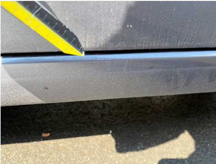
Schweller links (Lackschaden, Kratzer)
