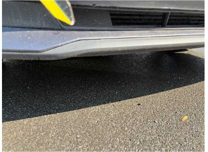
Stoßstange vorne (Lackschaden, Kratzer)
