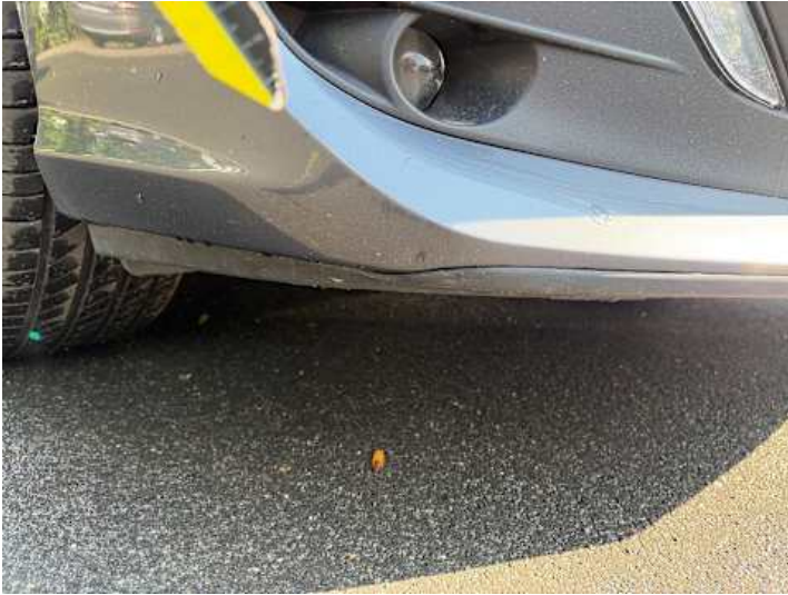
Stoßstange vorne (Lackschaden, Kratzer)
