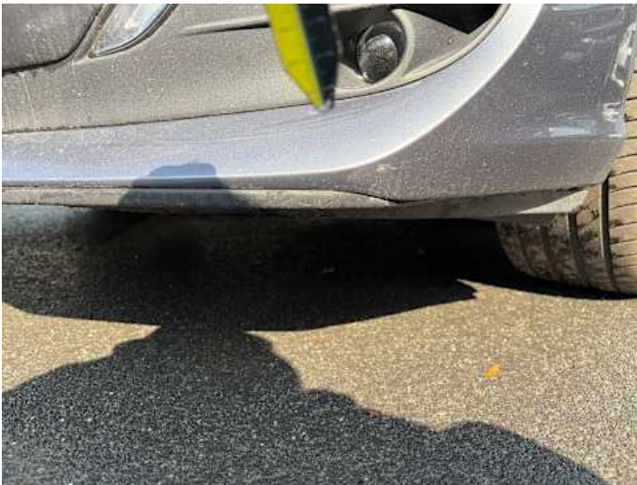
Stoßstange vorne (Lackschaden, Kratzer)
