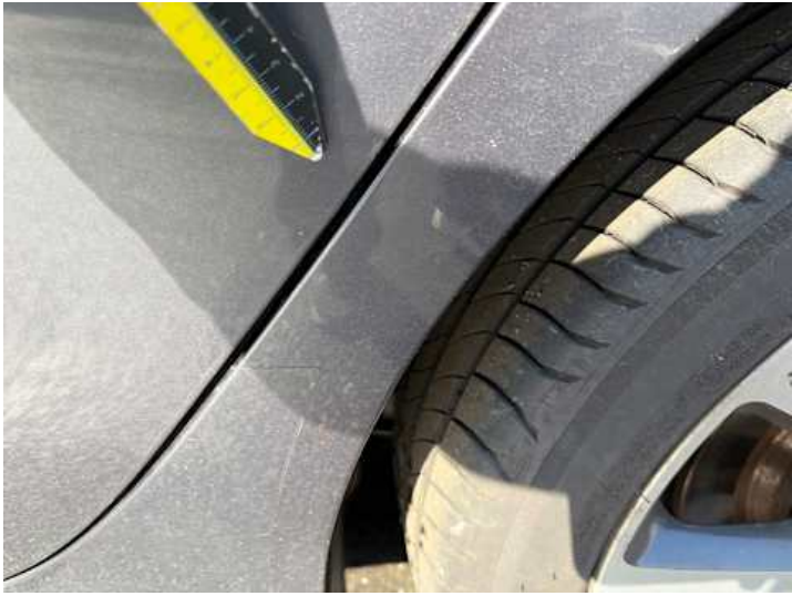
Seitenteil hinten links (Lackschaden, Kratzer)
