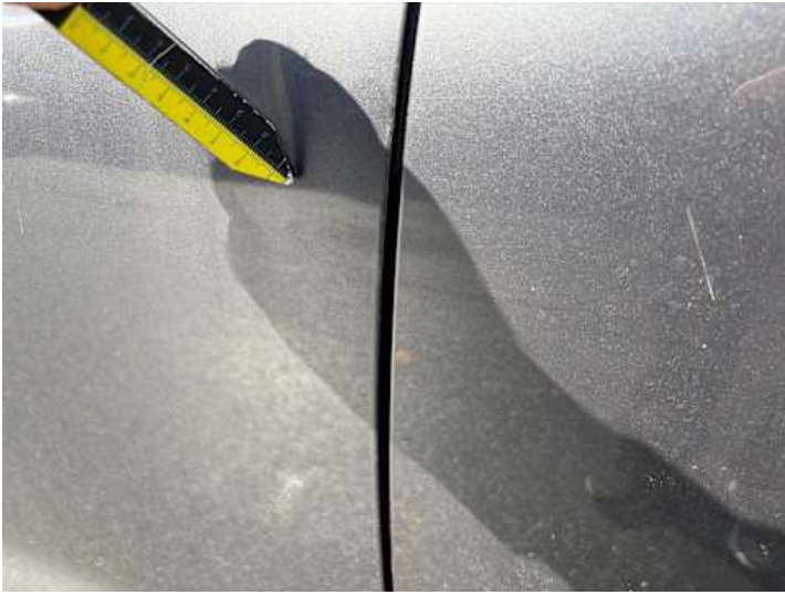
Fahrtür (Lackschaden, Kratzer)
