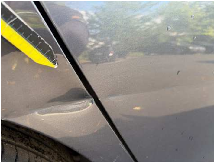
Türe hinten rechts (Lackschaden, Kratzer)
