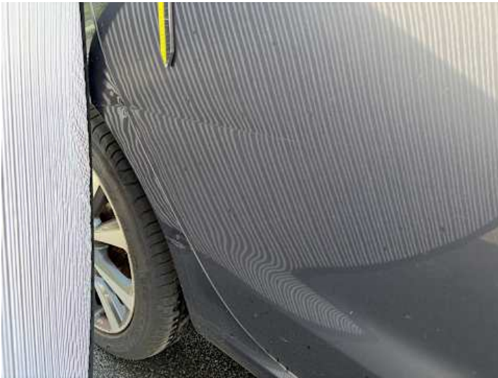
Türe hinten rechts (Verformung, Delle)
