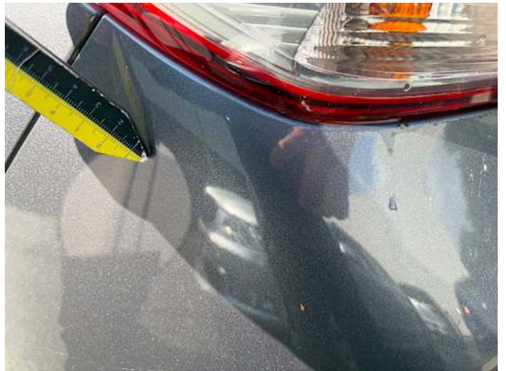
Stoßstange hinten (Lackschaden, Kratzer)
