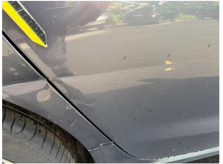
Türe hinten rechts (Lackschaden, Kratzer)
