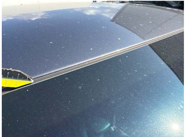
Dach (Lackschaden, Steinschlag)
