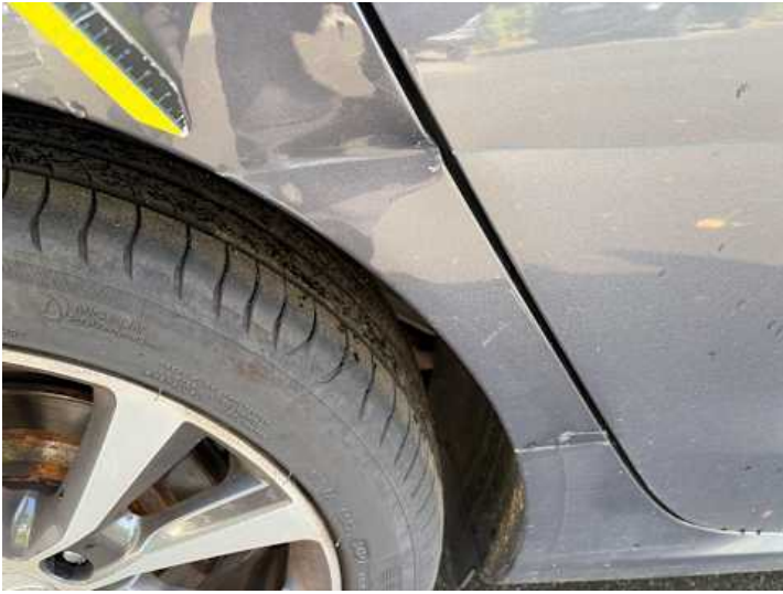
Seitenteil hinten rechts (Lackschaden, Kratzer)
