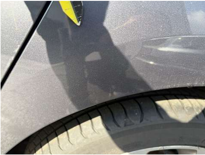
Seitenteil hinten links (Lackschaden, Kratzer)
