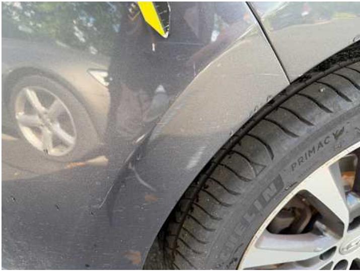
Stoßstange hinten (Lackschaden, Kratzer)
