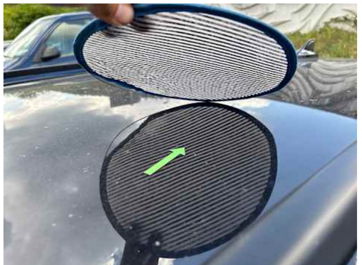
Dach (Delle, Steinschlag)
