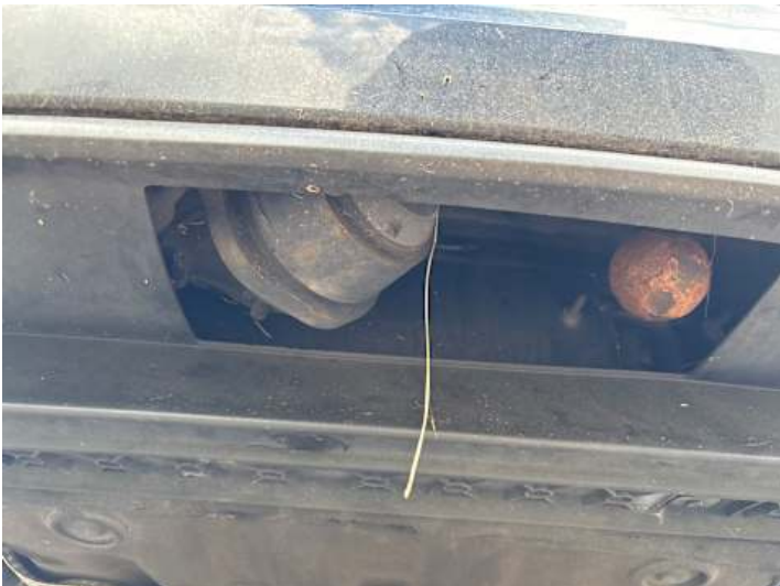
Innenraum (Anderer Schaden): Anhängerkupplung klappt nicht aus
