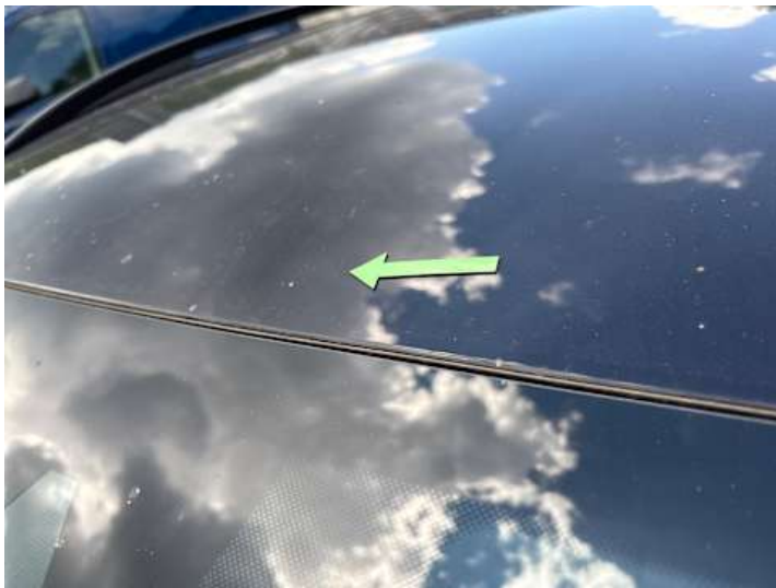
Dach (Delle, Steinschlag)
