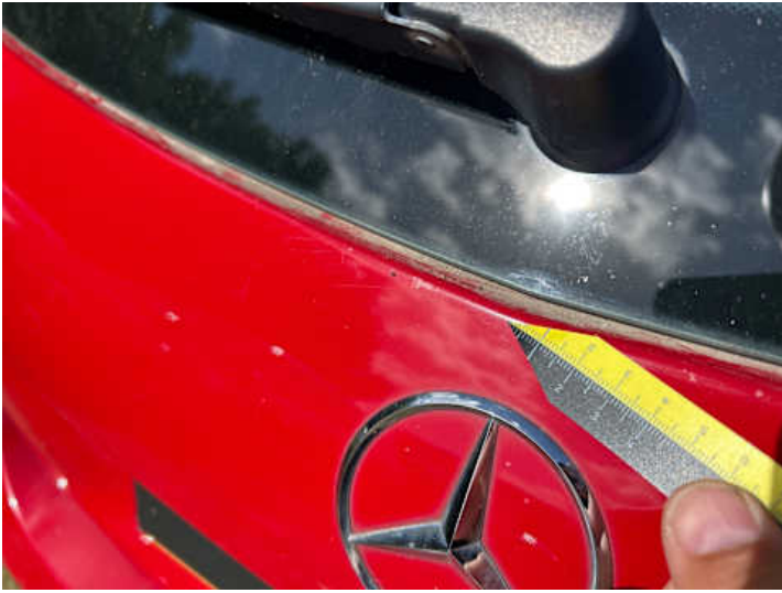
Heckklappe (Lackschaden, Kratzer)
