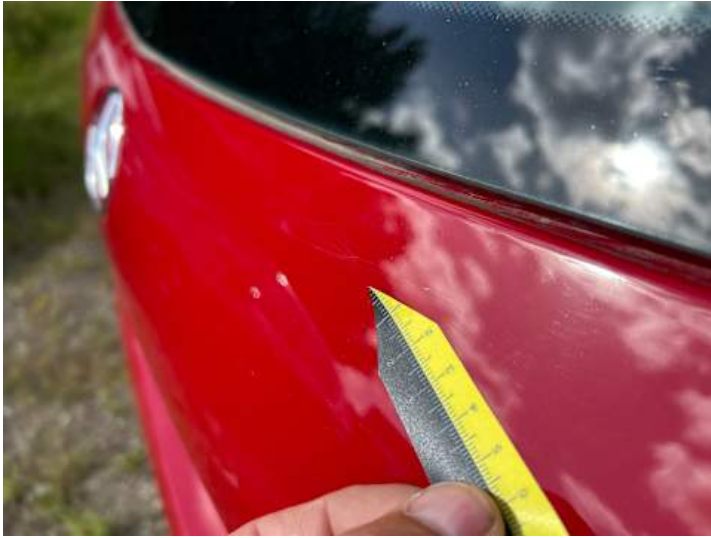
Heckklappe (Lackschaden, Kratzer)
