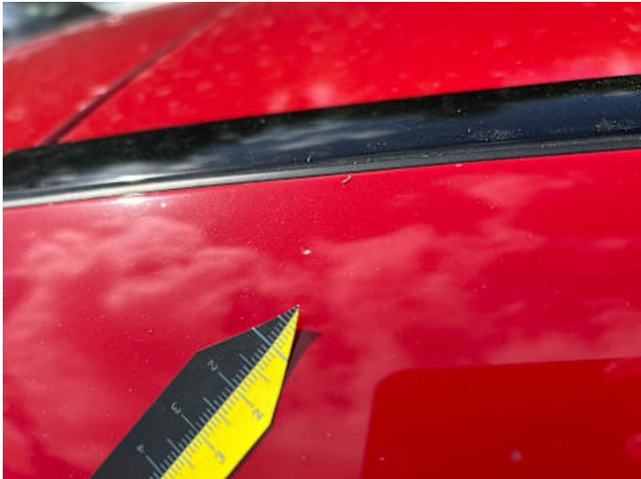
Seitenteil hinten rechts (Lackschaden)
