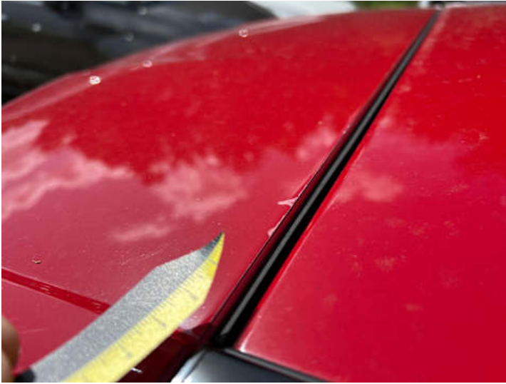
Heckklappe (Lackschaden, Kratzer)
