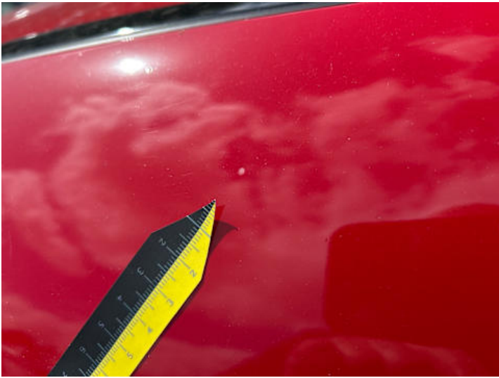
Seitenteil hinten rechts (Lackschaden)
