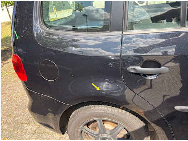
Seitenteil hinten rechts (Kratzer)
