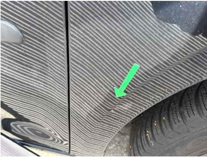
Kotflügel vorne rechts (Kratzer, Delle)
