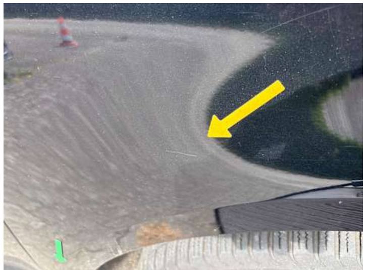
Kotflügel vorne rechts (Kratzer, Delle)
