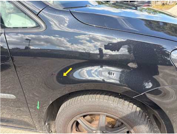
Kotflügel vorne rechts (Kratzer, Delle)
