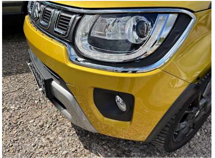
Stoßstange vorne (Riss/Bruch, Spaltmaße ungenau)
