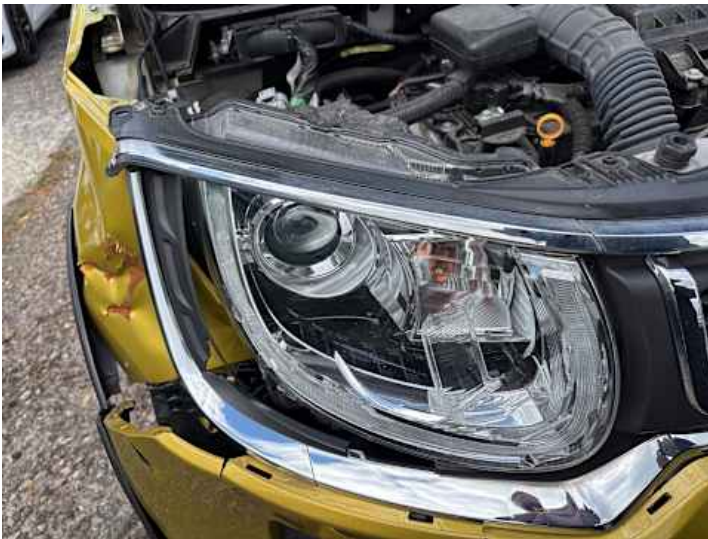
Scheinwerfer (rechts) (Riss/Bruch)
