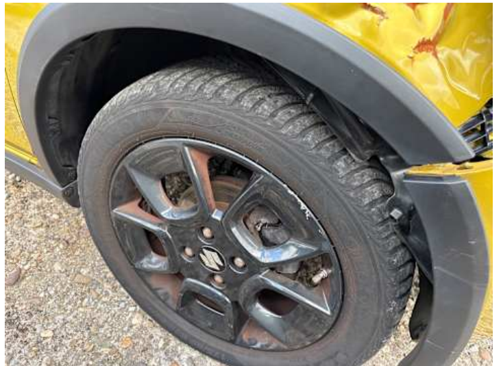
Rad (Kratzer, Ungleichmäßig abgefahren)
