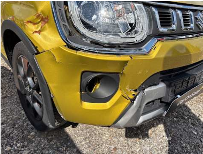
Stoßstange vorne (Riss/Bruch, Spaltmaße ungenau)
