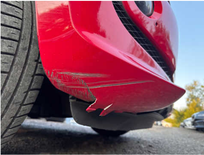
Stoßstange vorne (Riss/Bruch, Verformung, Lackschaden)
