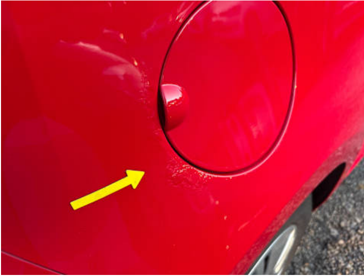
Seitenteil hinten rechts (Rost)
