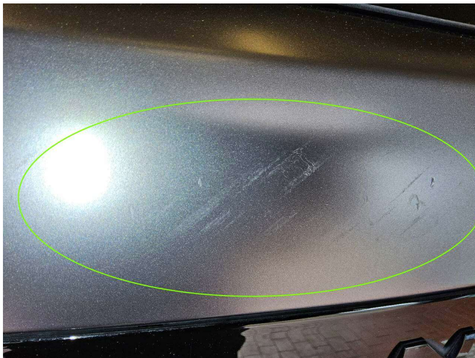
Bild 13 : Heckklappe matt lackiert, oberhalb verschrammt
