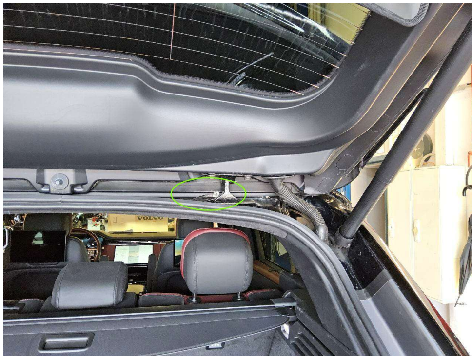
Bild 8 : Laderaumrahmen oben rechts loses Masseband, befestigen
