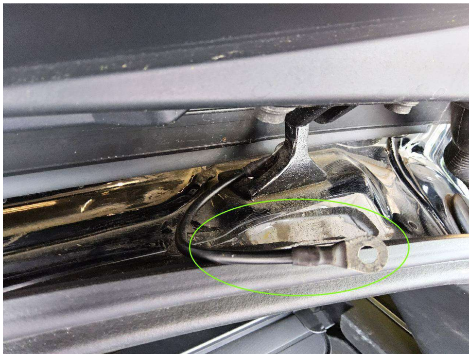
Bild 9 : Laderaumrahmen oben rechts loses Masseband, befestigen
