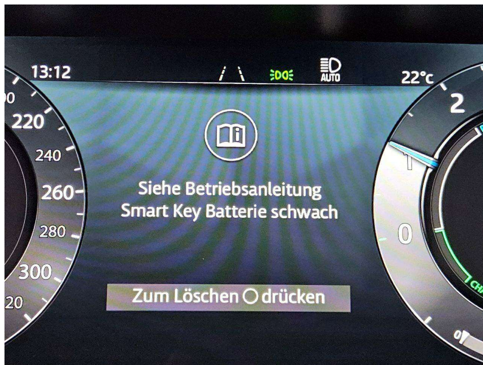
Bild 7 : Beide Funk-Fahrzeugschlüssel Batterie schwach
