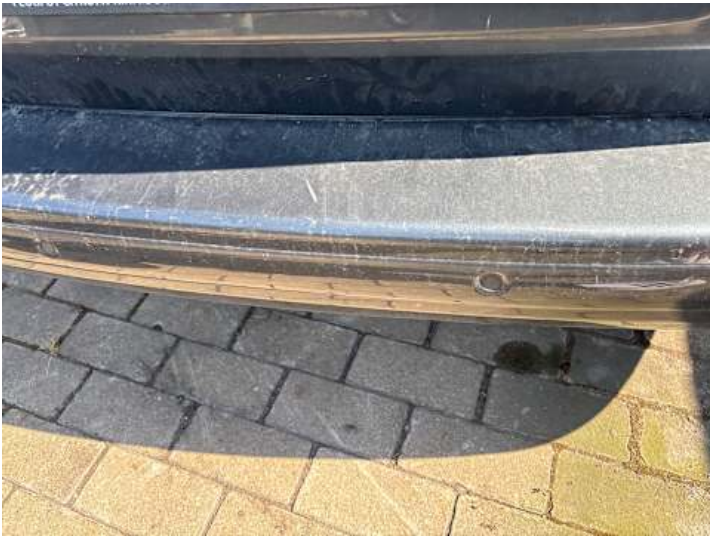
Stoßstange hinten (Kratzer)
