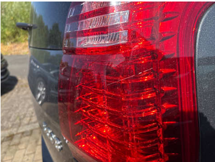
Rücklicht (rechts) (Kratzer)
