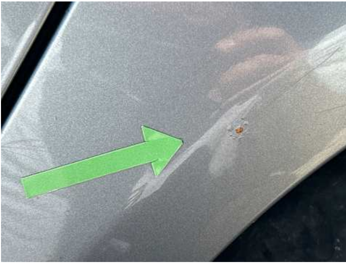
Seitenteil hinten links (Rost)
