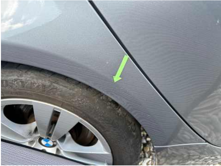
Seitenteil hinten rechts (Delle, Rost)
