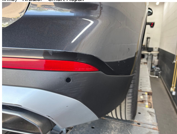
Beschädigung 8: Stossfänger hinten: Stossfänger hinten (unlackiert) - verkratzt / verschürft - erneuern
