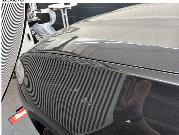
Beschädigung 9: Kotflügel links: Kotflügel links - Kratzer - lackieren
