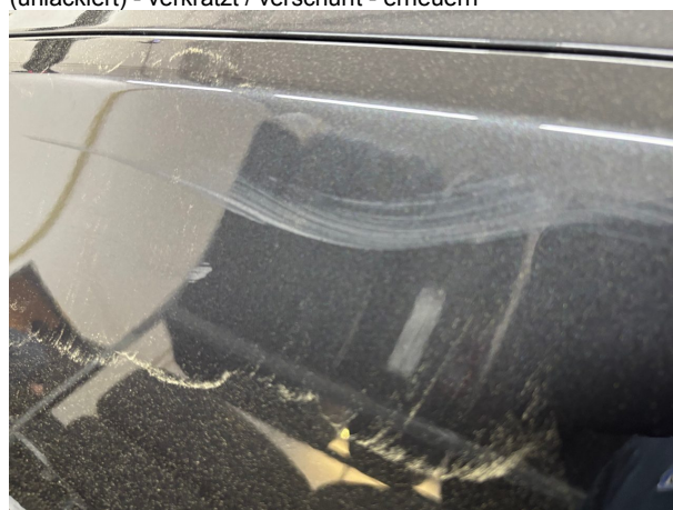
Beschädigung 9: Kotflügel links: Kotflügel links - Kratzer - lackieren
