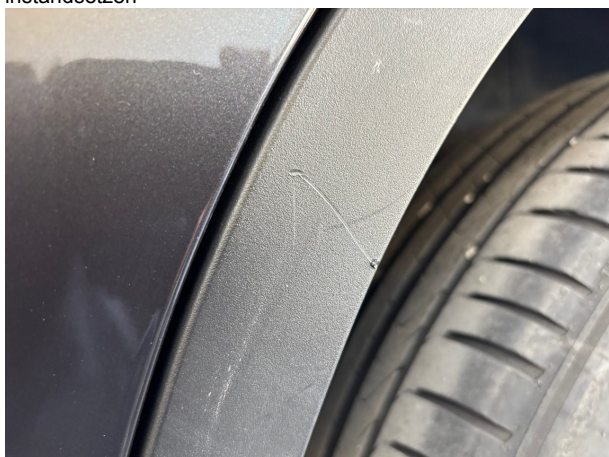
Beschädigung 2: Seitenwand links: Radhausverbreiterung - verkratzt / verschürft - erneuern
