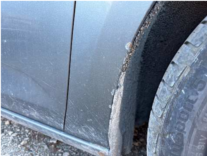
Kotflügel vorne rechts (Rost, Lackschaden)
