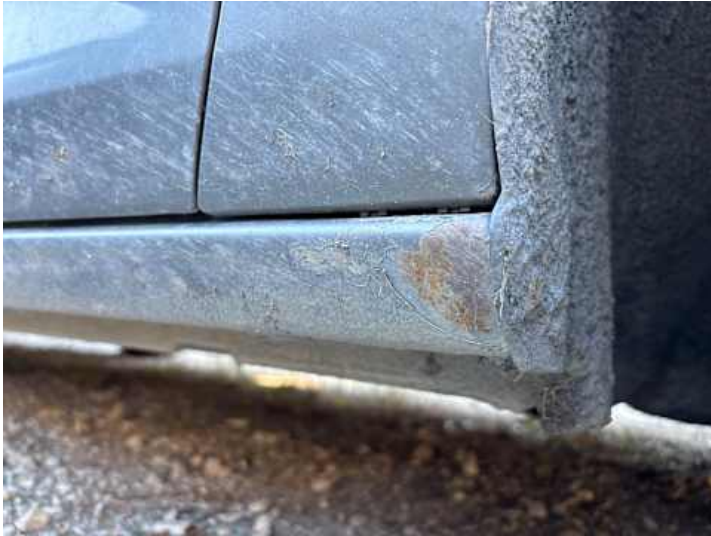
Schweller rechts (Rost, Lackschaden)
