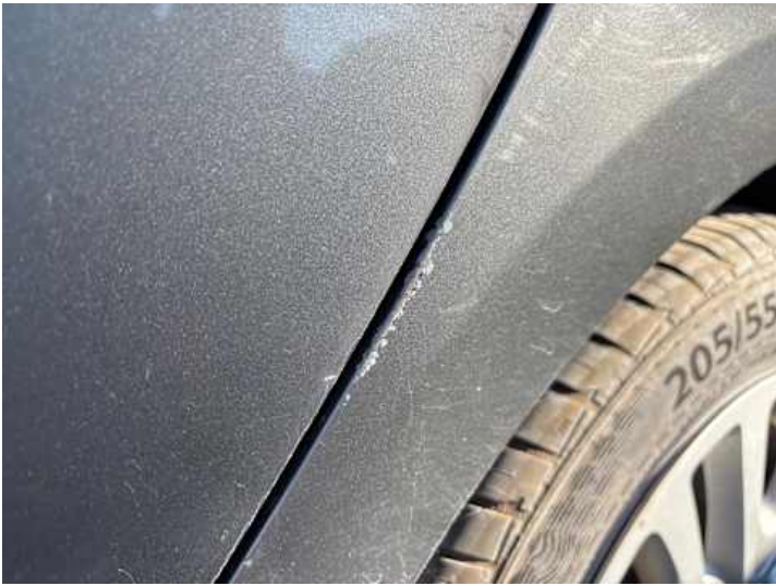
Seitenteil hinten links (Lackschaden)
