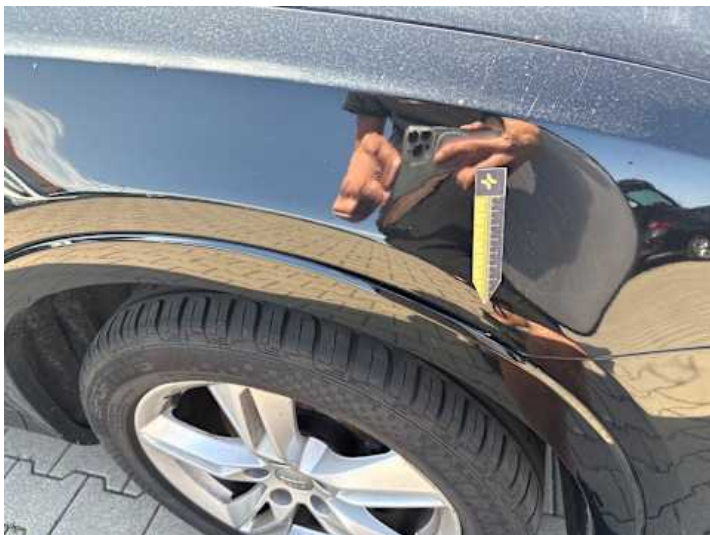
Kotflügel vorne rechts (Spaltmaße ungenau)
