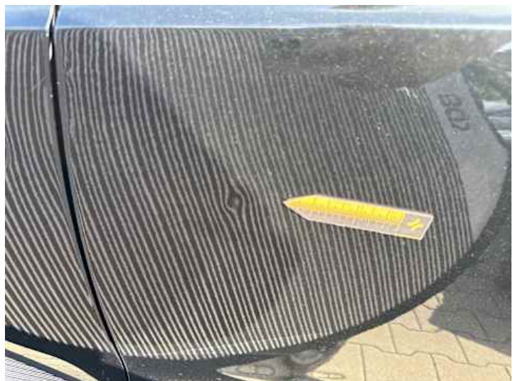
Türe hinten links (Delle)
