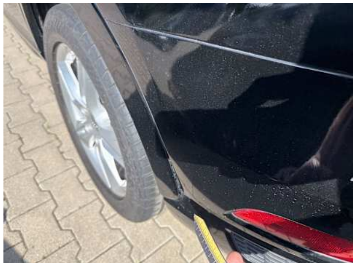
Seitenteil hinten links (Spaltmaße ungenau)
