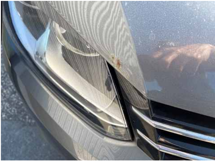
Motorhaube (Lackschaden, Rost, Kratzer)
