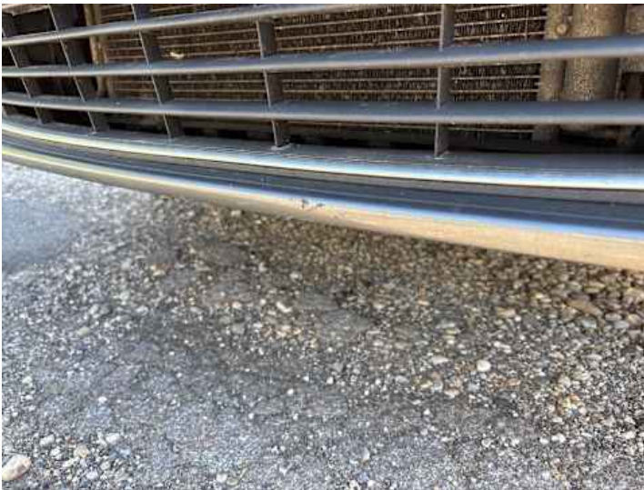
Stoßstange vorne (Kratzer)
