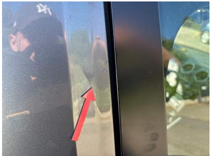
Türe hinten rechts (Kratzer)
