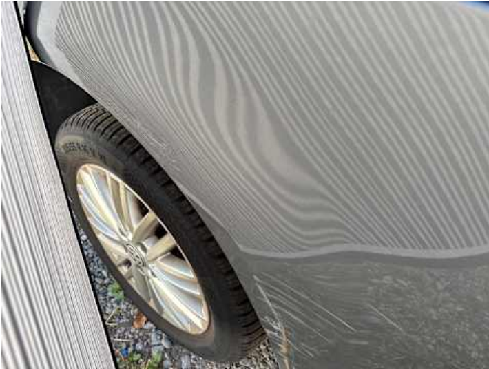
Seitenteil hinten rechts (Kratzer, Verformung)
