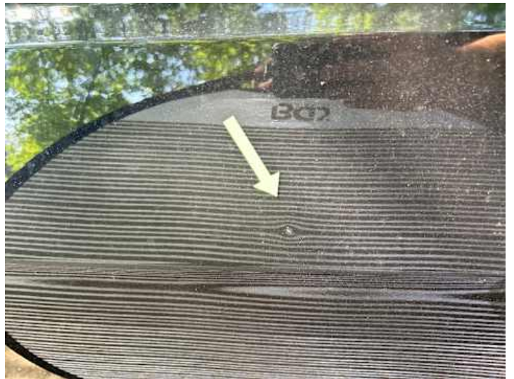
Türe hinten links (Delle)
