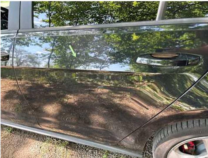
Türe hinten links (Delle)
