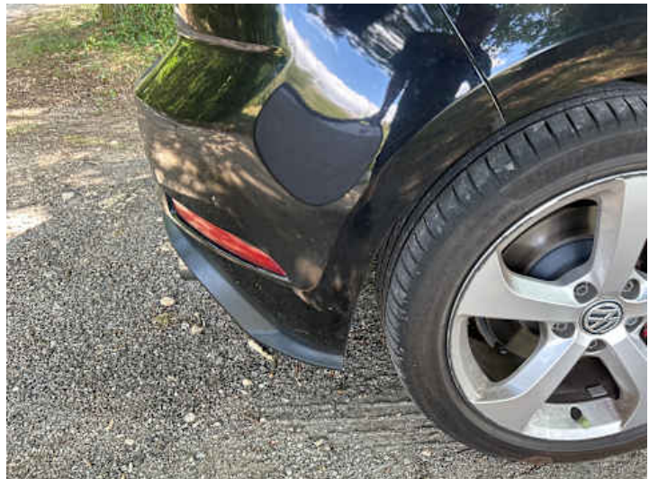
Stoßstange hinten (Unsachgemäß instand gesetzt)
