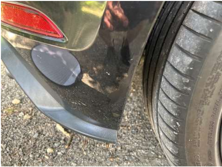
Stoßstange hinten (Unsachgemäß instand gesetzt)
