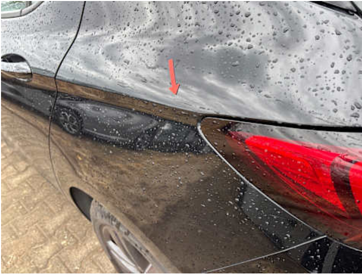
Seitenteil hinten links (Lackschaden)
