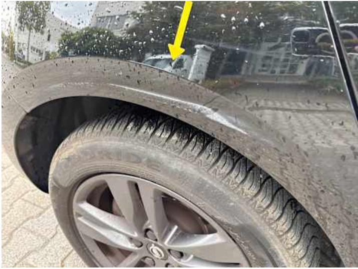
Seitenteil hinten rechts (Lackschaden)
