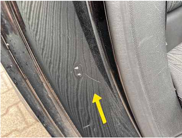
Türe hinten rechts (Delle, Lackschaden)
