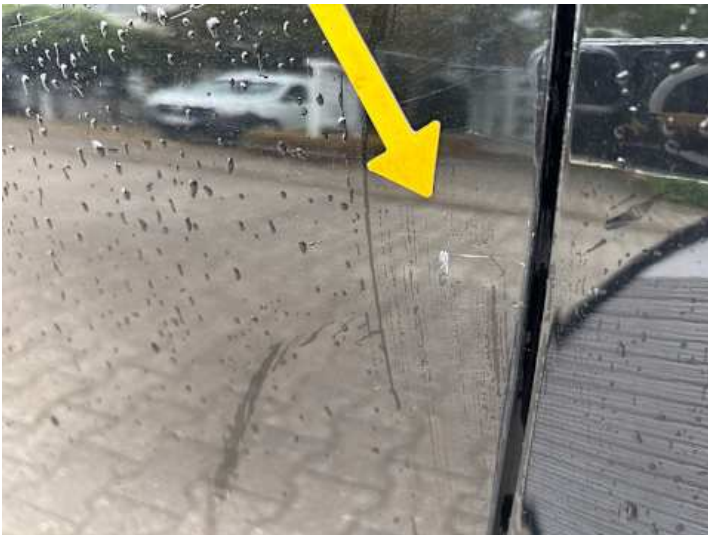
Türe hinten rechts (Lackschaden)
