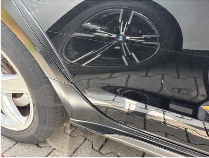
Türe hinten rechts (Kratzer, Lackschaden)
