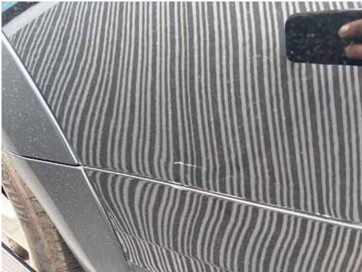
Seitenteil hinten links (Delle, Kratzer)
