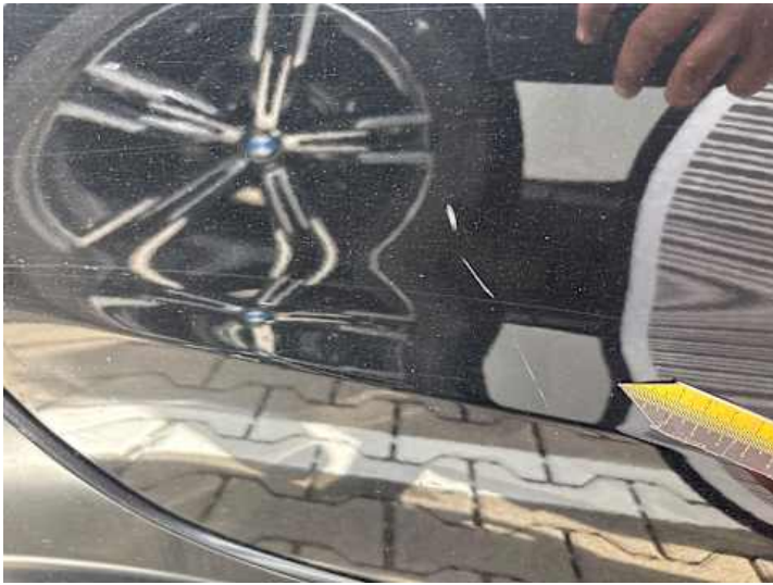
Türe hinten rechts (Kratzer, Lackschaden)
