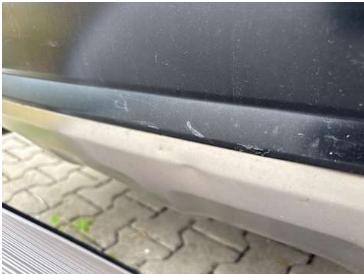
Stoßstange hinten (Delle)
