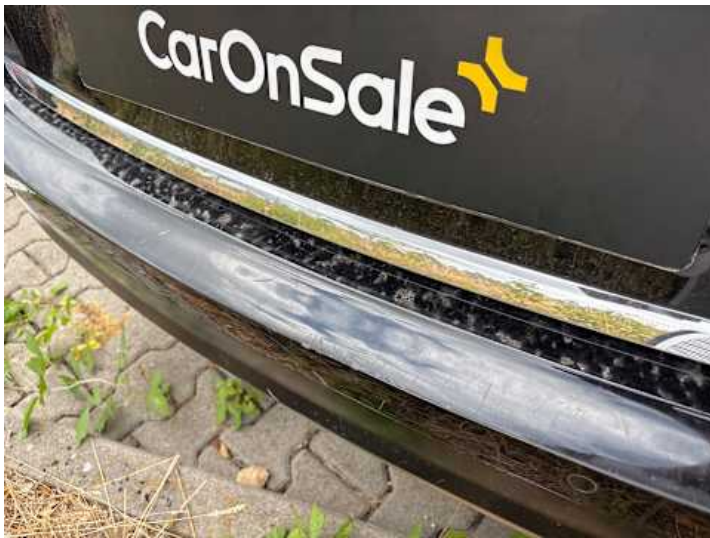
Stoßstange hinten (Lackschaden, Kratzer)
