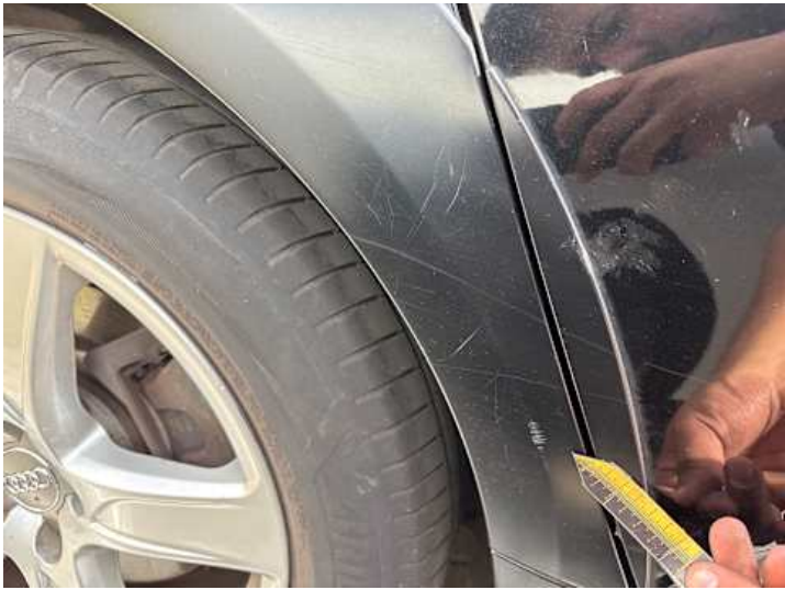
Seitenteil hinten rechts (Kratzer)
