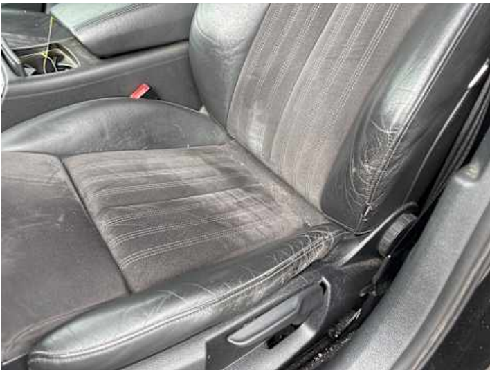
Innenraum (Verschleiß, Kratzer)
