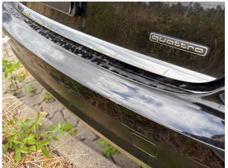
Stoßstange hinten (Lackschaden, Kratzer)
