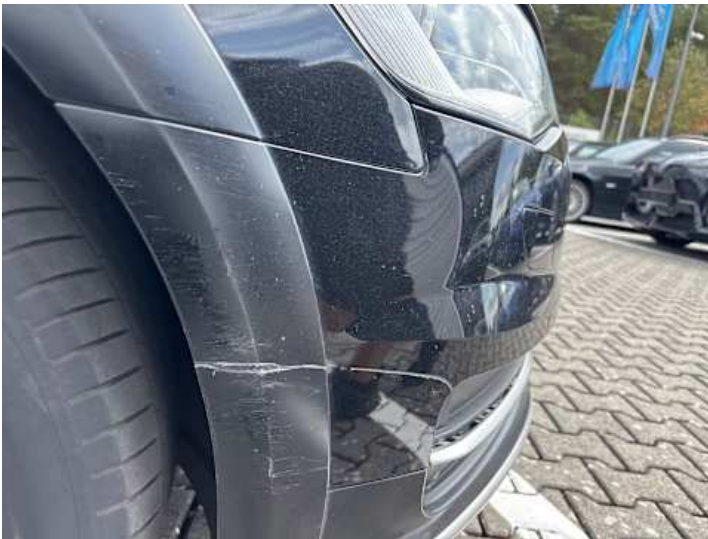
Stoßstange vorne (Lackschaden, Kratzer)
