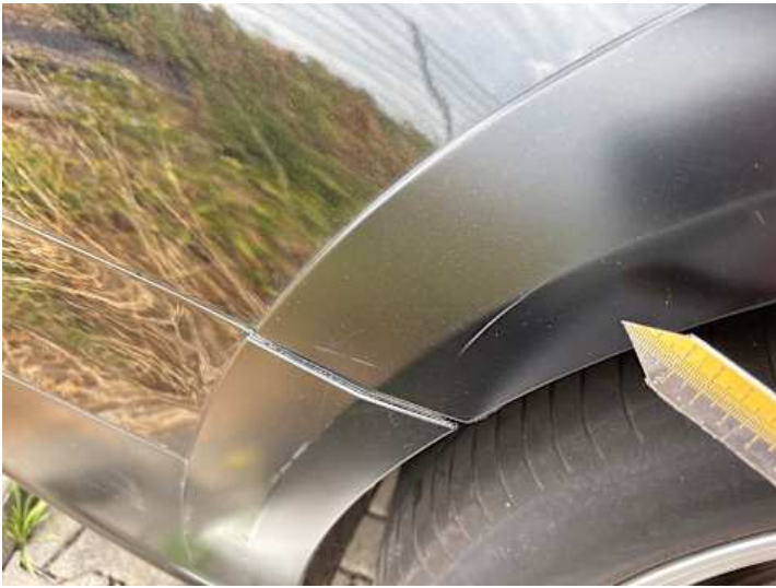
Seitenteil hinten rechts (Kratzer)
