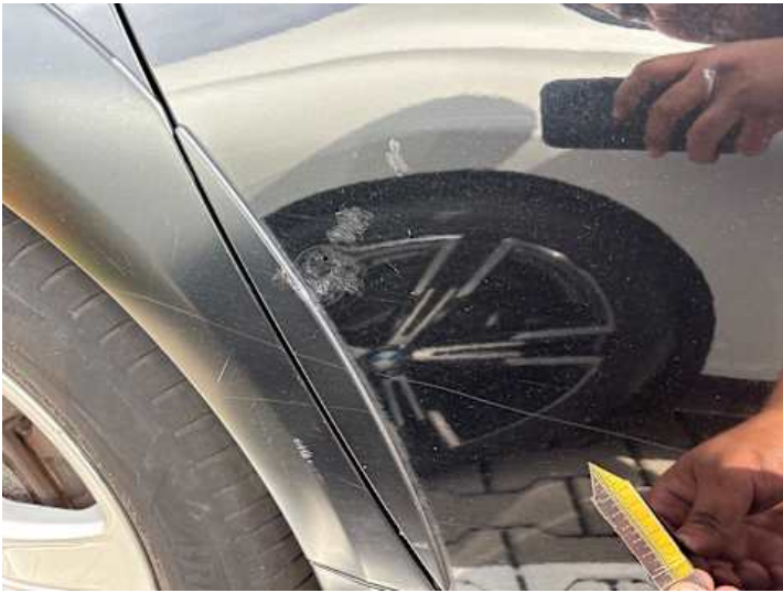
Türe hinten rechts (Kratzer, Lackschaden)
