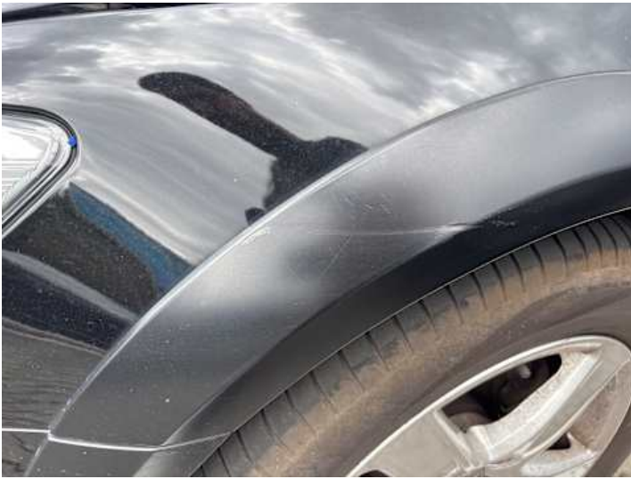
Kotflügel vorne links (Kratzer)
