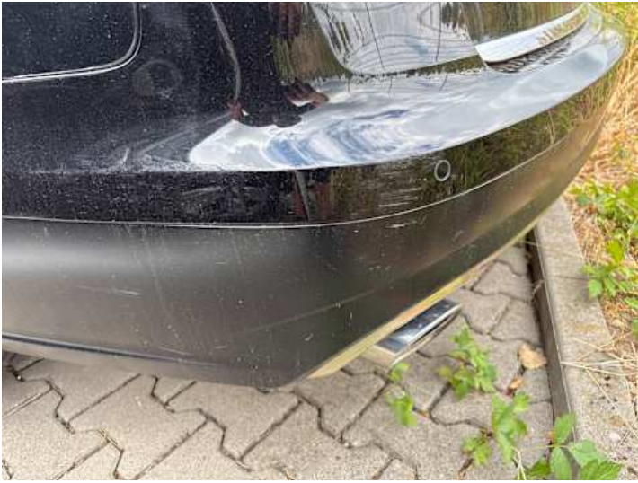
Stoßstange hinten (Lackschaden, Kratzer)
