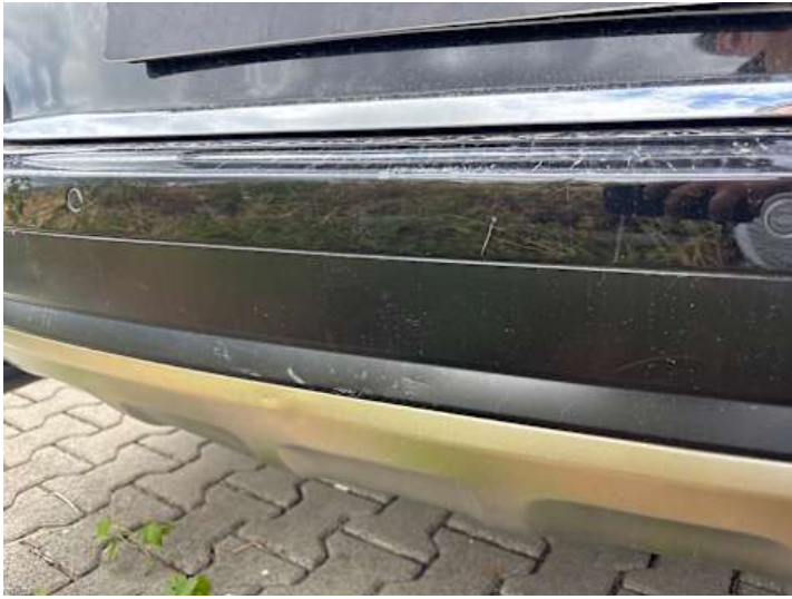
Stoßstange hinten (Lackschaden, Kratzer)
