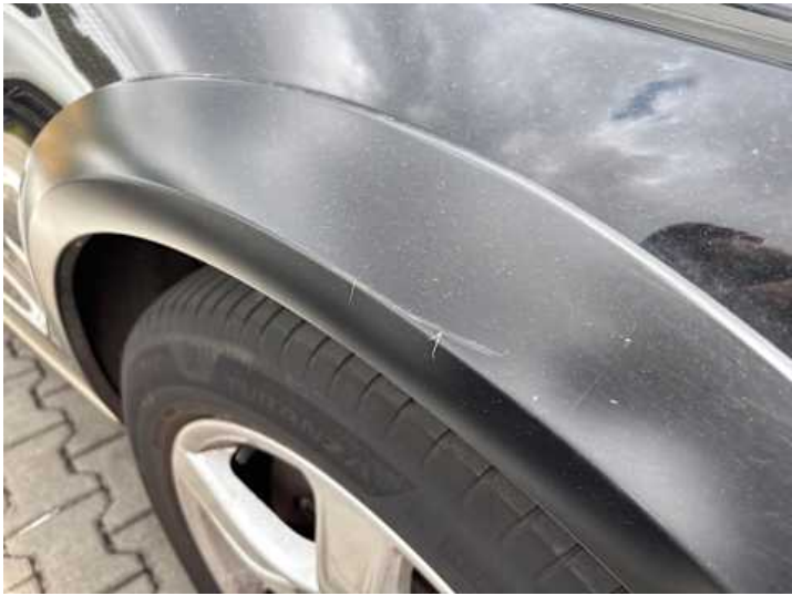
Kotflügel vorne rechts (Kratzer)
