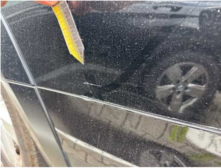
Seitenteil hinten links (Delle, Kratzer)
