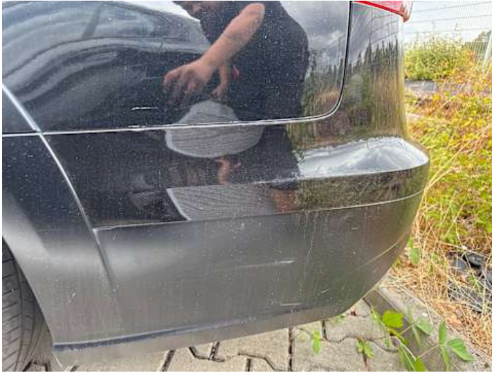
Stoßstange hinten (Lackschaden, Kratzer)
