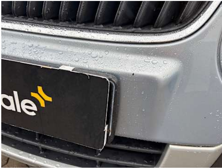
Stoßstange vorne (Kratzer, Lackschaden)
