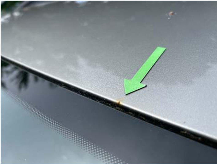
Dach (Lackschaden, Steinschlag)
