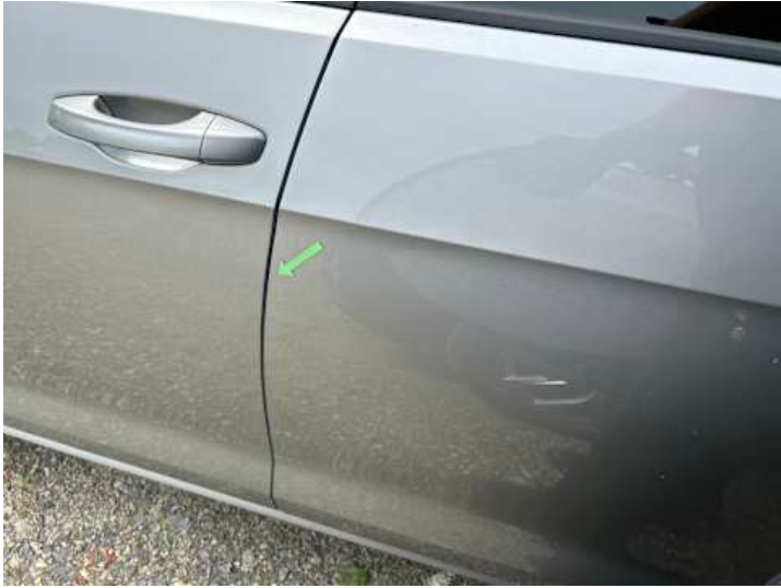
Türe hinten links (Lackschaden)
