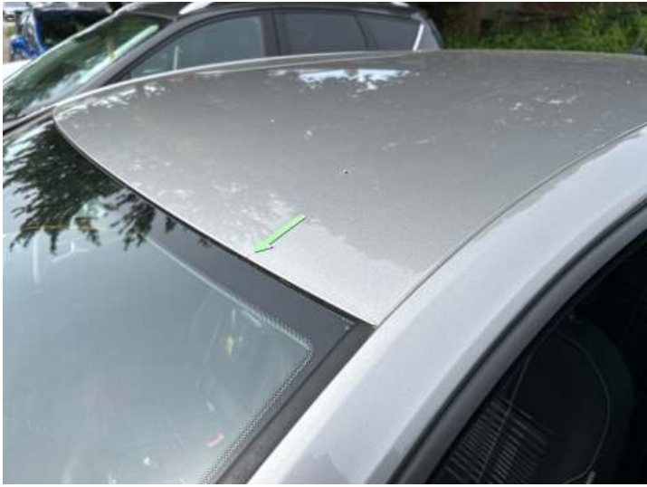
Dach (Lackschaden, Steinschlag)
