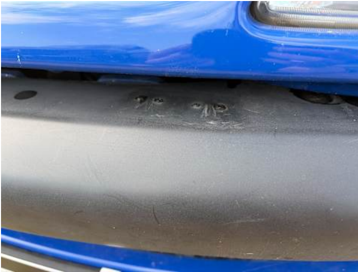
Stoßstange vorne (Anderer Schaden, Lackschaden): Schraubenlöcher
