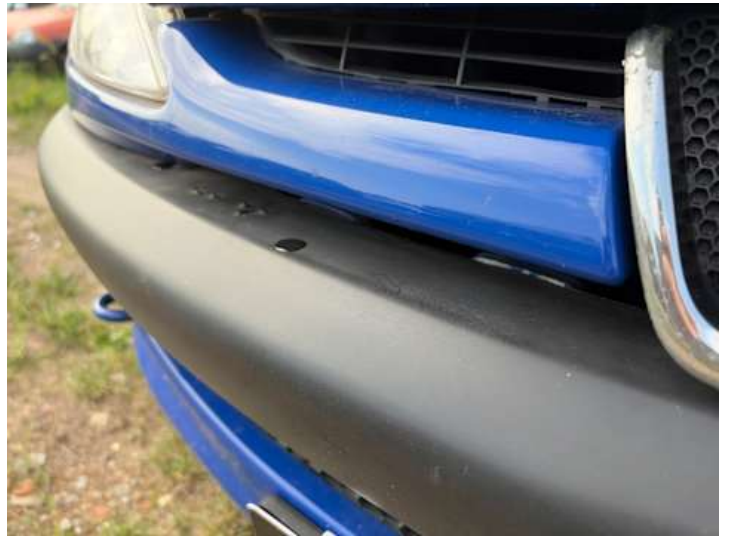
Stoßstange vorne (Anderer Schaden, Lackschaden): Schraubenlöcher
