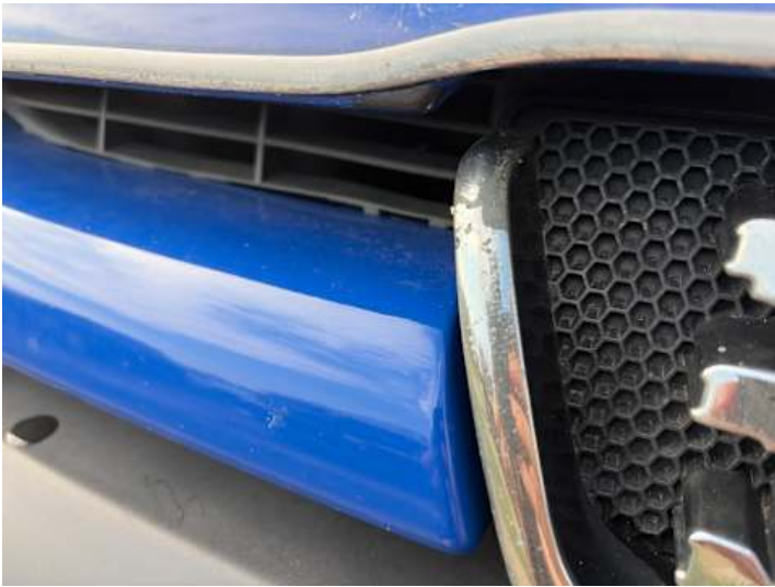
Stoßstange vorne (Anderer Schaden, Lackschaden): Schraubenlöcher
