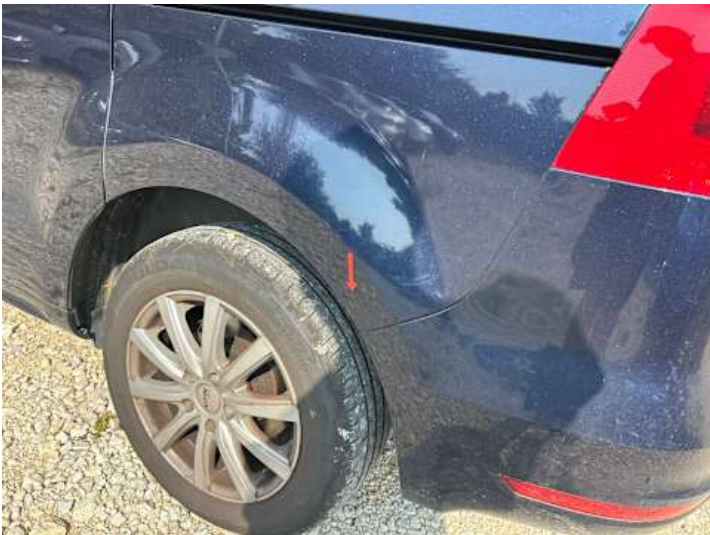
Seitenteil hinten links (Rost)
