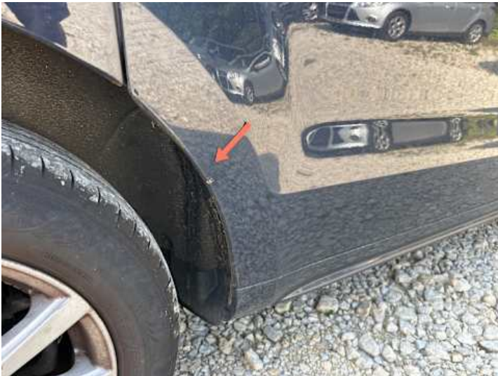
Türe hinten rechts (Kratzer, Rost)
