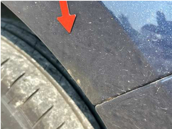
Seitenteil hinten links (Rost)
