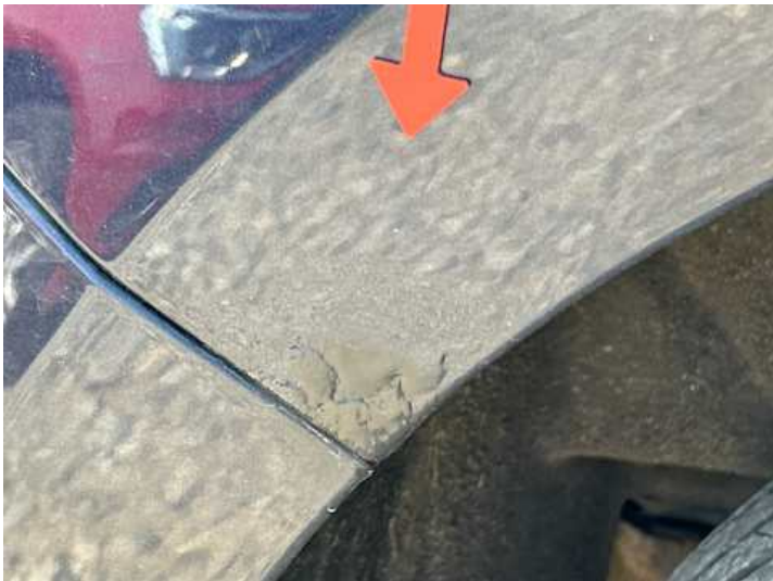
Seitenteil hinten rechts (Rost)
