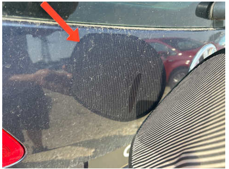
Heckklappe (Ausgeblichen/Matt, Unsachgemäß instand gesetzt)
