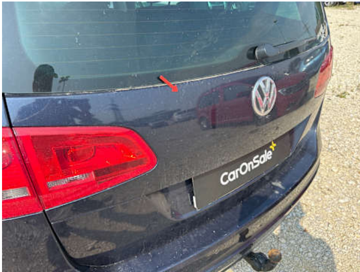
Heckklappe (Ausgeblichen/Matt, Unsachgemäß instand gesetzt)
