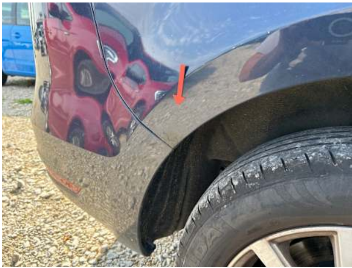
Seitenteil hinten rechts (Rost)
