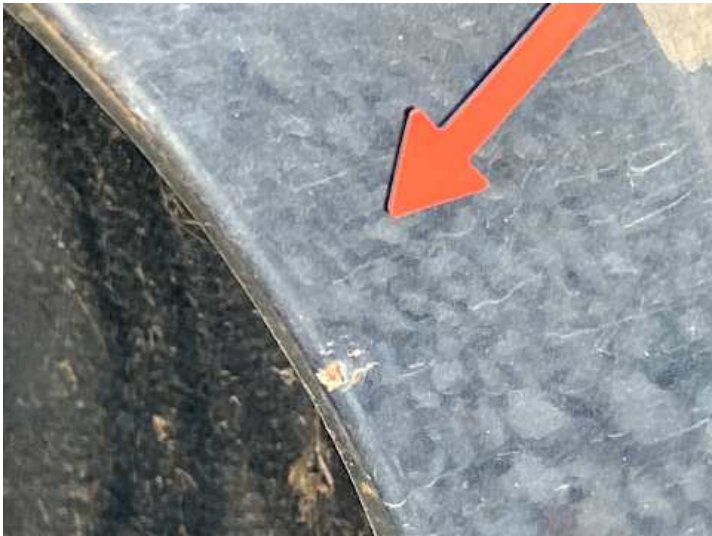
Türe hinten rechts (Kratzer, Rost)
