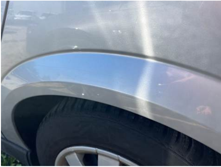
Seitenteil hinten links (Lackschaden, Kratzer)
