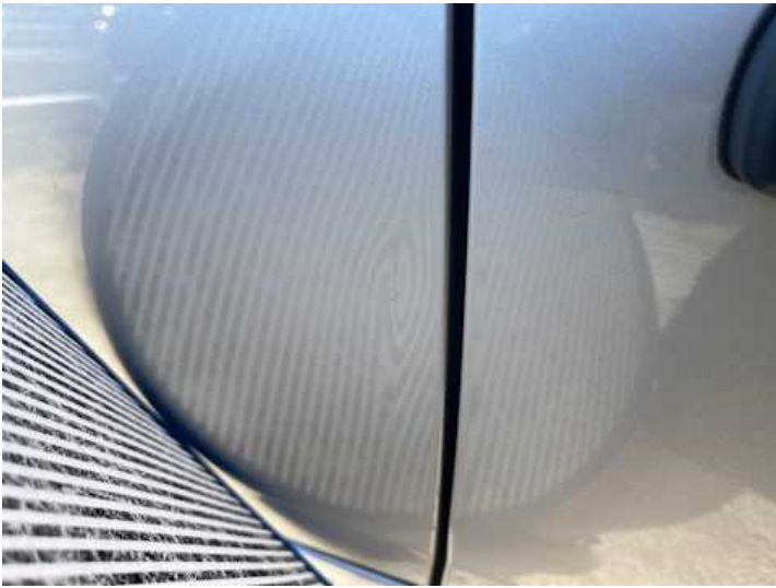
Türe hinten rechts (Delle)
