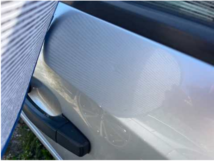
Türe hinten links (Delle)
