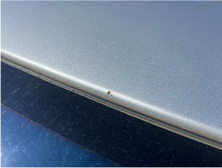
Dach (Lackschaden, Rost)
