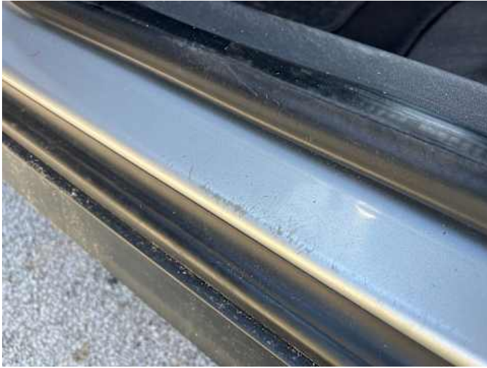
Schweller links (Lackschaden, Kratzer)
