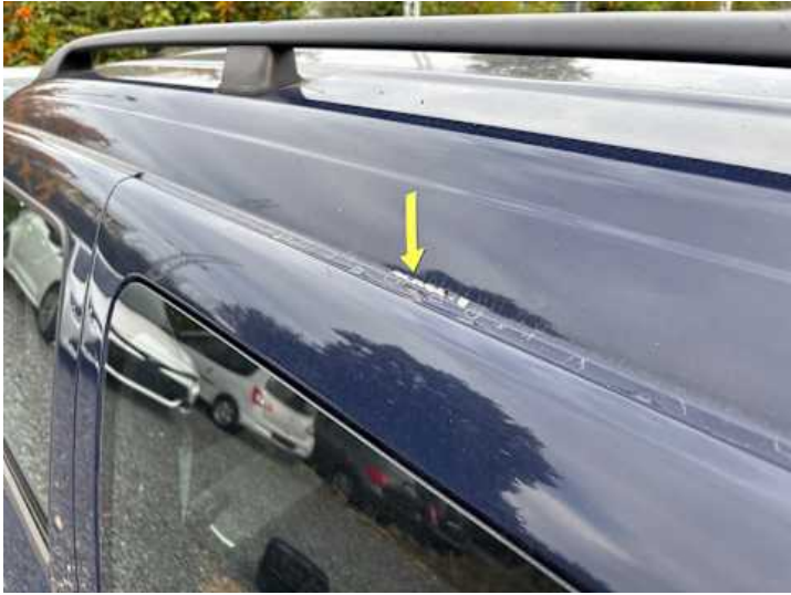
Seitenteil hinten links (Lackschaden)
