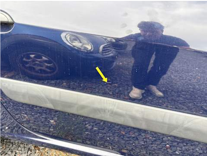
Türe hinten rechts (Kratzer, Delle)
